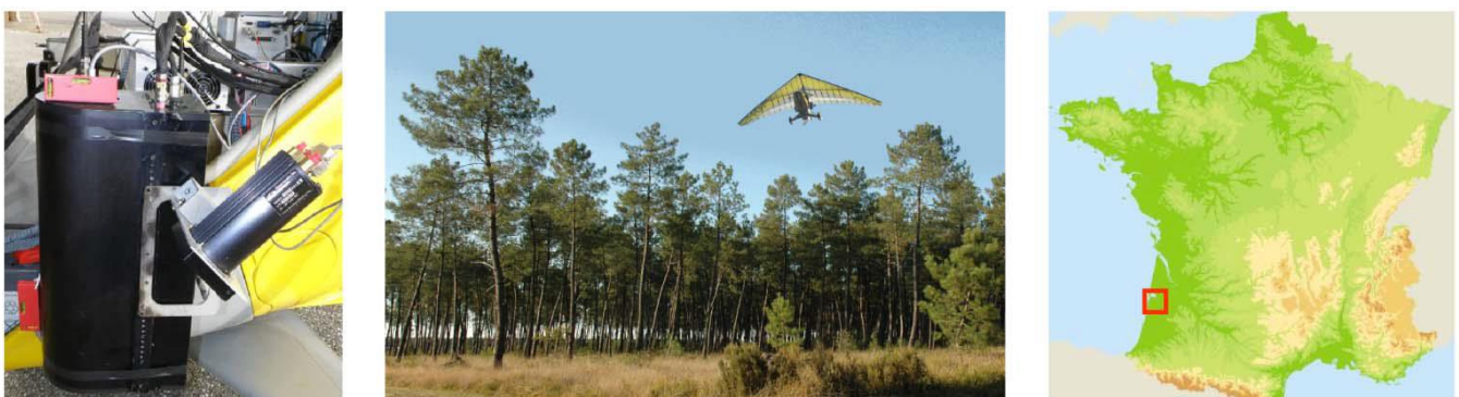
Figure 3.1. Gauche : lidar LAUVAC (Lidar Aéroporté UltraViolet pour l'Atmosphère et la Canopée forestière) embarqué sur ULM. Milieu : ULM survolant la forêt des Landes. Droite : Localisation de la forêt des Landes (carré rouge) en France. (Cuesta et al., 2010)
