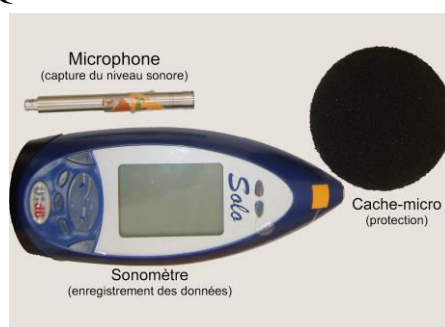
Figure 7: Microphone et sonomètre pour l'estimation de l'exposition au bruit environnemental. Crédit photo Quentin Tenailleau.
