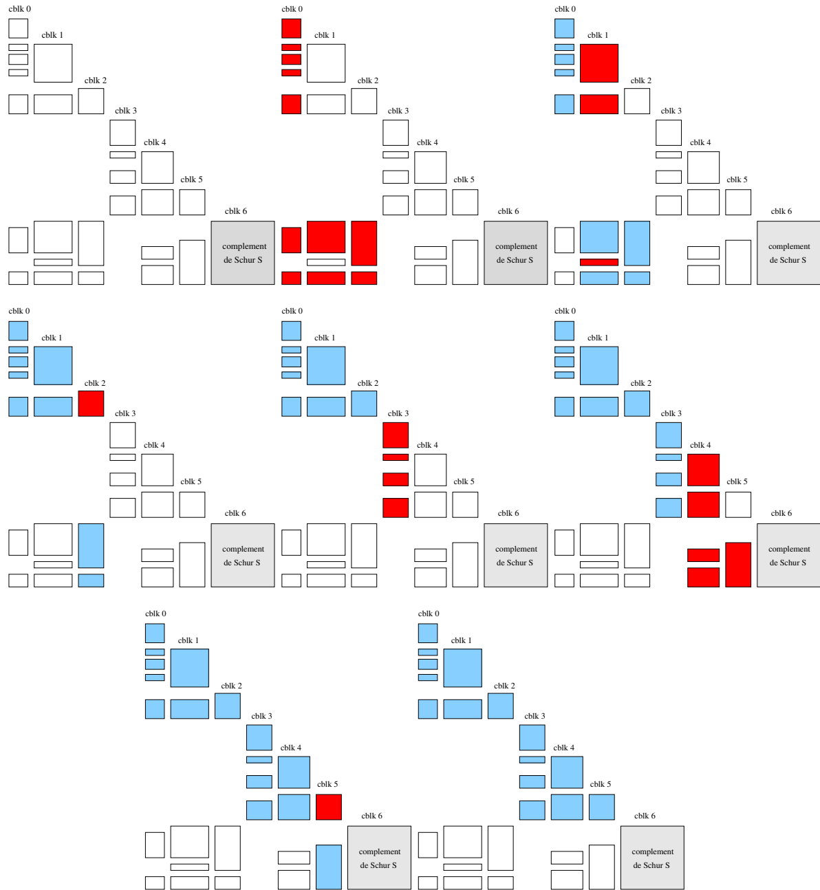
FIGURE 2.7 – Illustration de l’algorithme left-right-looking. Un seul domaine est montré, factorisé avec un unique processus. Les conventions pour les couleurs sont les mêmes que dans la figure 2.6.
