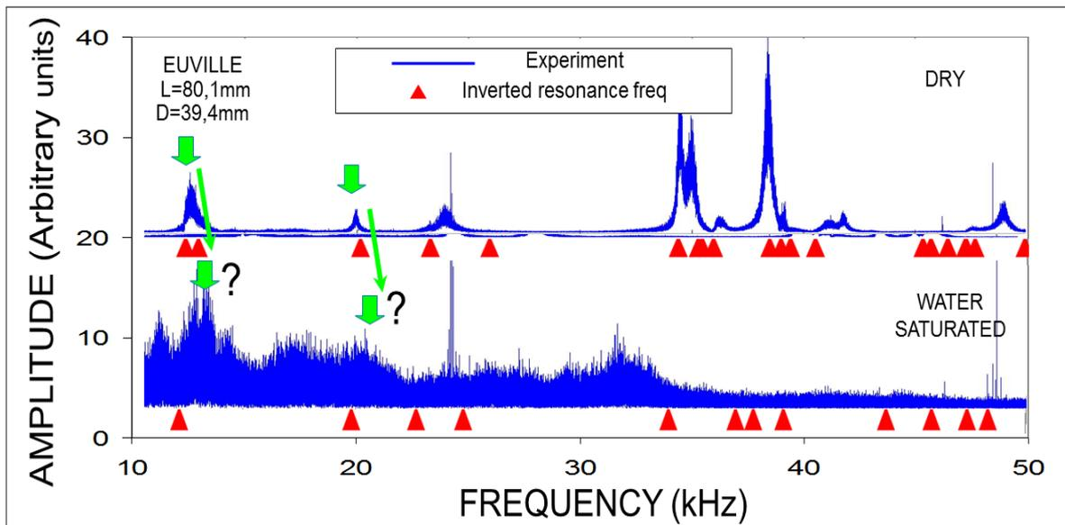
Figure 53: Même chose qu'en figure 52 mais pour un cylindre de calcaire d'Euville (diamètre  $D=4\text{cm}$  et longueur  $L=8\text{cm}$ ).
