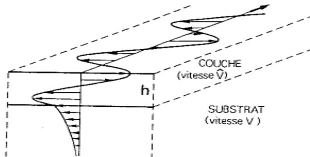
Figure 6 : onde de Love : onde transversale se propageant dans une couche et dans son substrat (si  $v_T > V$  avec  $v_T$  vitesse dans le substrat et  $V$  vitesse dans la couche). L'épaisseur du substrat en vibration est d'autant plus grande que la fréquence est basse ( $\lambda > h$ ). (modifié d'après Royer et Dieulesaint, 1996)
