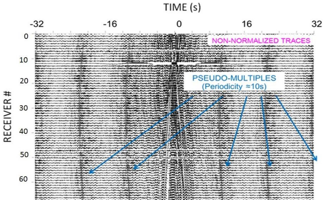
Figure 79 : Corrélations entre le capteur 12 et tous les autres (la douzième trace correspond donc à l'autocorrélation). Les pseudos-multiples correspondent au bruit des pompes. Les corrélations ne sont pas normalisées afin de mieux voir ces signaux
