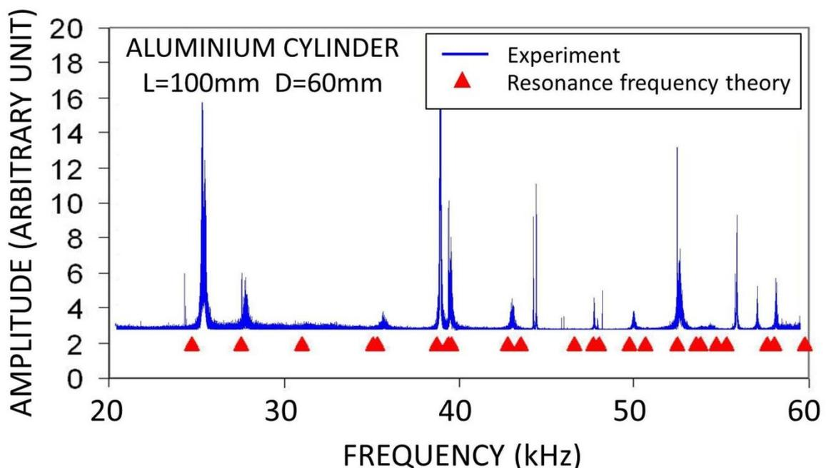
Figure 46: Courbe expérimentale de résonance (courbe bleue) d'un cylindre d'aluminium (diamètre  $D=6$  cm et longueur  $L=10$  cm) comparée aux fréquences de résonance théoriques (triangles rouges) correspondant aux constantes élastiques mesurées indépendamment par la méthode du pulse ultrasonore transmis.
