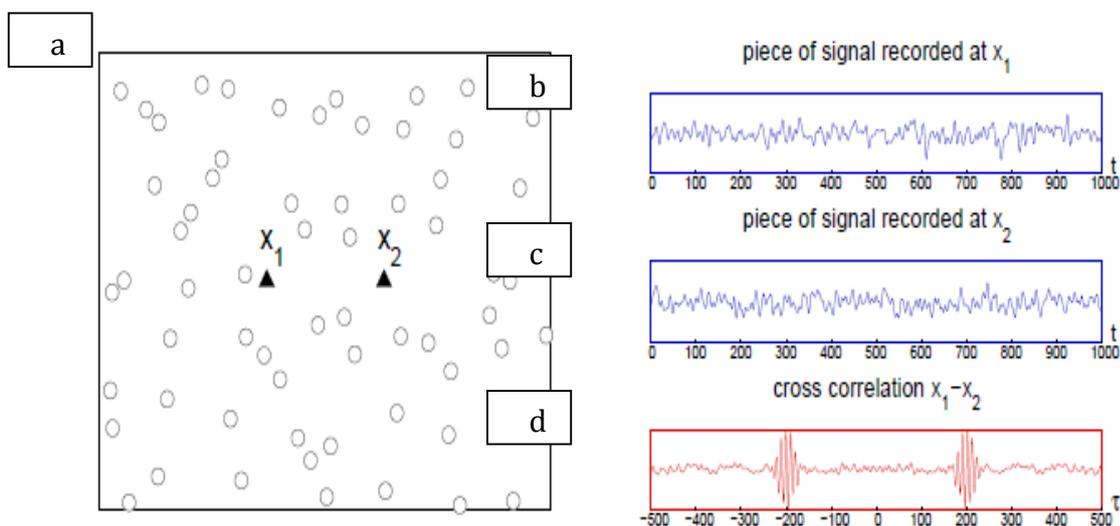
Figure 9 : a) distribution de sources aléatoire (les cercles représentent les sources) dans laquelle deux capteurs,  $x_1$  et  $x_2$  sont placés. b) signal enregistré par le capteur 1. c) signal enregistré par le capteur 2. d) corrélation temporelle des signaux 1 et 2. (d'après Garnier 2009)
