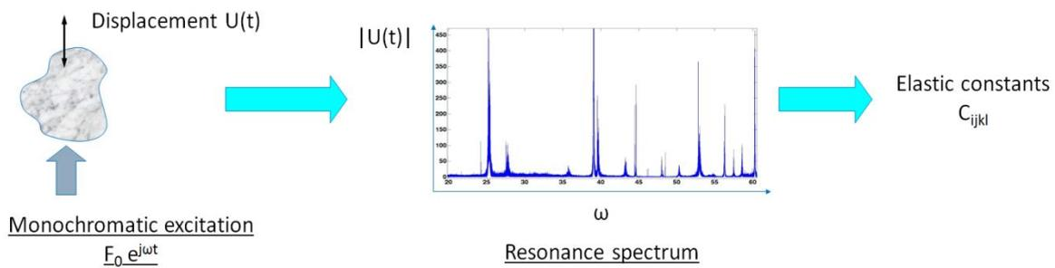
Figure 28 : Principe de la Spectroscopie par Résonance Ultrasonore.  $U(t)$  est le déplacement induit par l'excitation  $F_0 \exp(j\omega t)$  ( $\omega$  est la pulsation).  $C_{ijkl}$  sont les constantes élastiques de l'échantillon étudié
