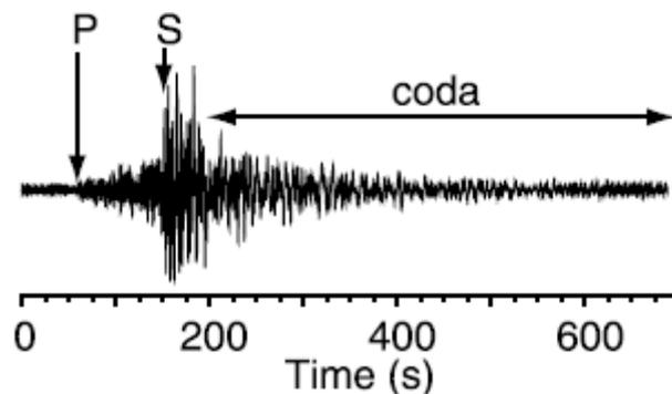
Figure 7 : exemple de signal sismique avec arrivées des ondes P, S, puis de la coda (D'après Campillo et Paul 2003)
