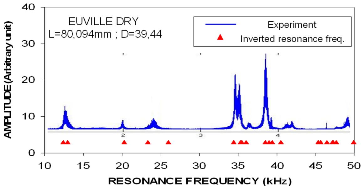
Figure 50 : Courbe de résonance expérimentale (ligne bleue) d'un cylindre de calcaire d'Euville sec (diamètre  $D=4\text{cm}$  et longueur  $L=8\text{cm}$ ) comparée aux fréquences de résonance théoriques (triangles rouges) correspondant au modèle inversé.
