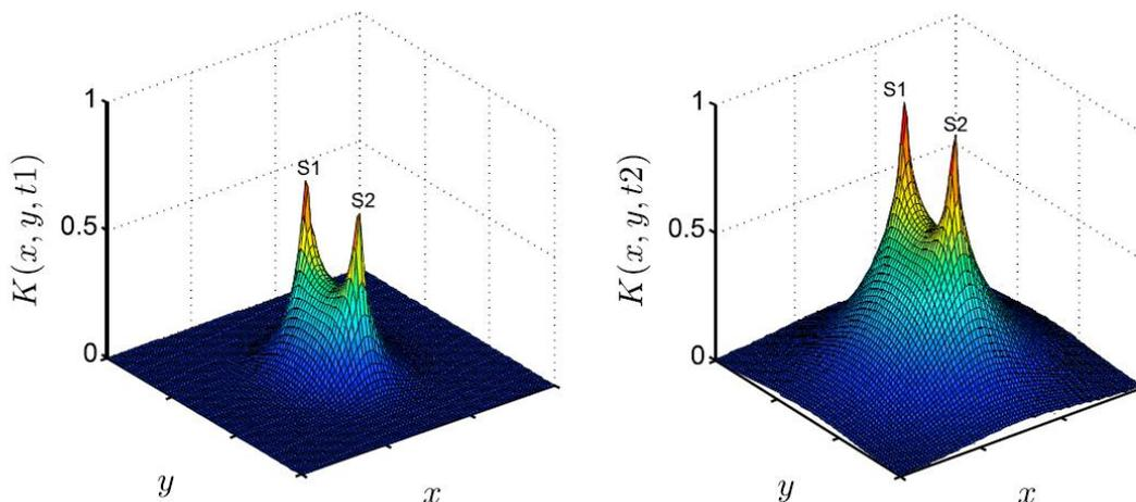
Figure 87 : Exemple de noyaux de sensibilité pour une paire de stations  $S_1$  et  $S_2$ ; à gauche, aux temps courts dans la coda, lorsque les ondes ont tout juste eu le temps de parcourir la distance  $S_1$ - $S_2$ ,  $t_1$ ; droite: à un temps bien plus long. La valeur sur l'axe vertical peut être interprétée comme la sensibilité de la variation de vitesse mesurée entre les deux stations à une variation de vitesse dans le milieu située en  $(x, y)$ . Modifié d'après Obermann et al. (2014)
