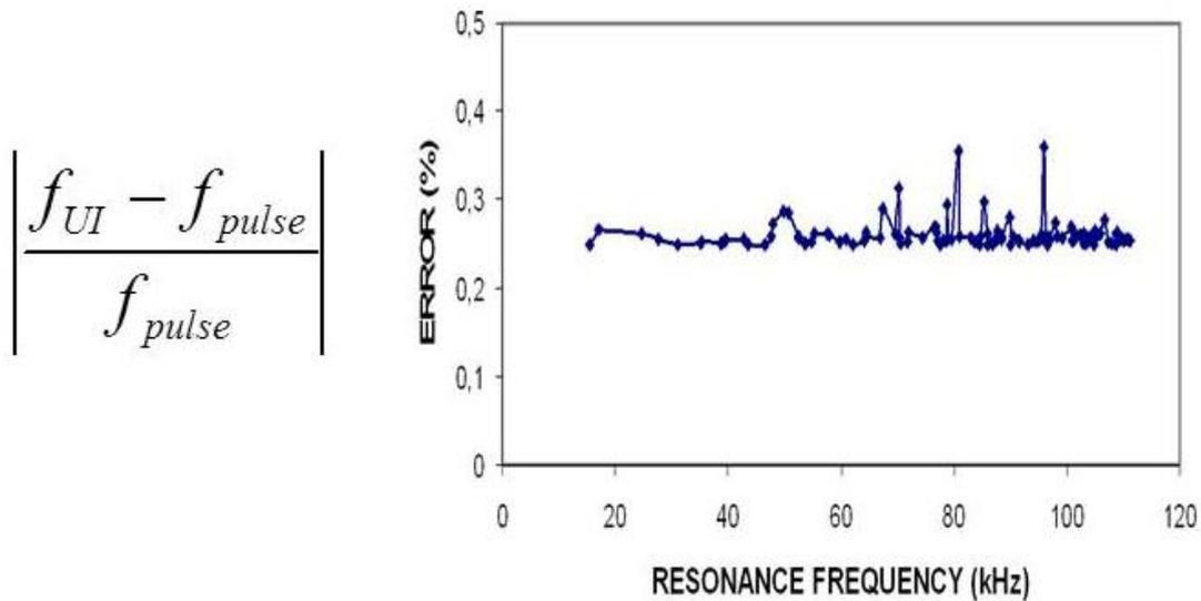
Figure 42: Différence relative en pourcents entre la fréquence de résonance  $f_{UI}$  correspondant au modèle inversé à partir des courbes expérimentales de résonance, et la fréquence de résonance  $f_{pulse}$  correspondant aux constantes élastiques mesurées indépendamment par la méthode conventionnelle de l'impulsion ultrasonore transmise, en fonction de la fréquence  $f_{puls}$ . Cas d'un cylindre d'aluminium (diamètre  $D=6\text{cm}$ , longueur  $L=10\text{cm}$ ).
