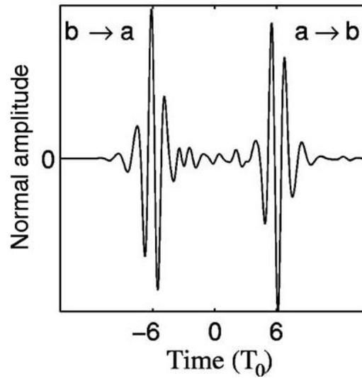
Figure 12: Corrélation typique obtenue dans cette expérience si  $a$  et  $b$  sont séparés de 6 longueurs d'onde. La partie négative (respectivement positive) correspond à la propagation de  $b$  vers  $a$  (resp. de  $a$  vers  $b$ ). (Modifié d'après Larose et al. (2006) )
