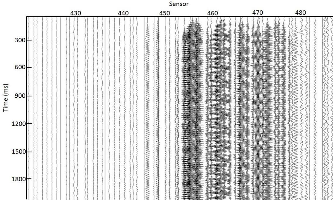
Figure 62 : Exemple d'enregistrements des géophones (20 secondes), traces brutes
