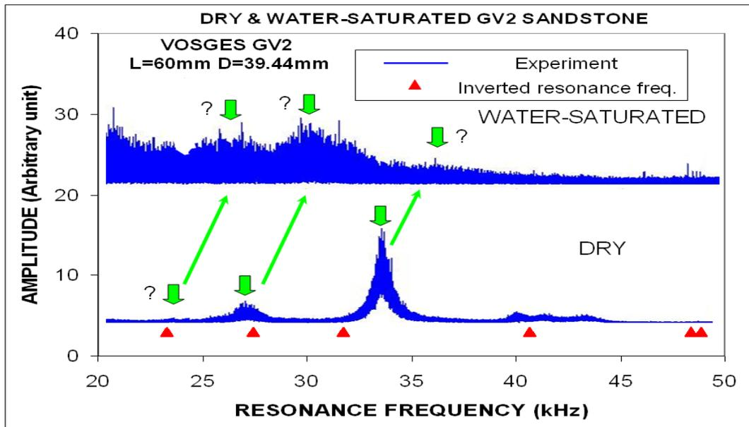
Figure 54: Même chose qu'en figure 52 mais pour un cylindre de grès des Vosges (diamètre  $D = 4\text{cm}$  et longueur  $L=6\text{cm}$ ).
