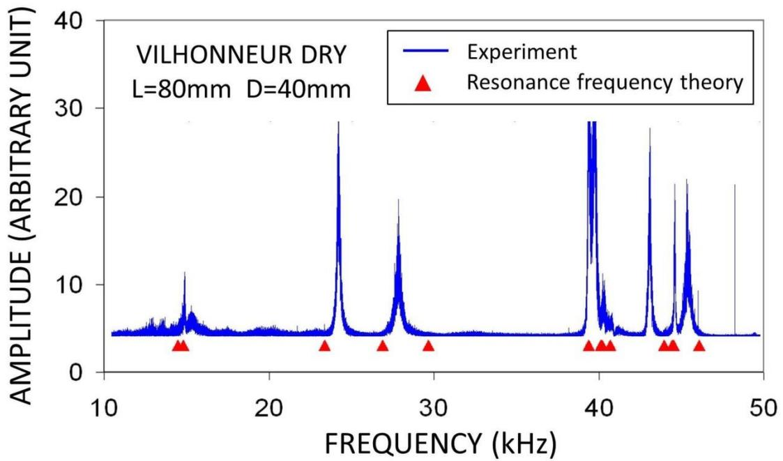
Figure 49 : Courbe expérimentale de résonance (ligne bleue) d'un cylindre de calcaire de Vilhonneur sec (diamètre  $D=4\text{cm}$  et longueur  $L=8\text{cm}$ ) comparée aux fréquences théoriques de résonance (triangles rouges) correspondant au modèle inversé.
