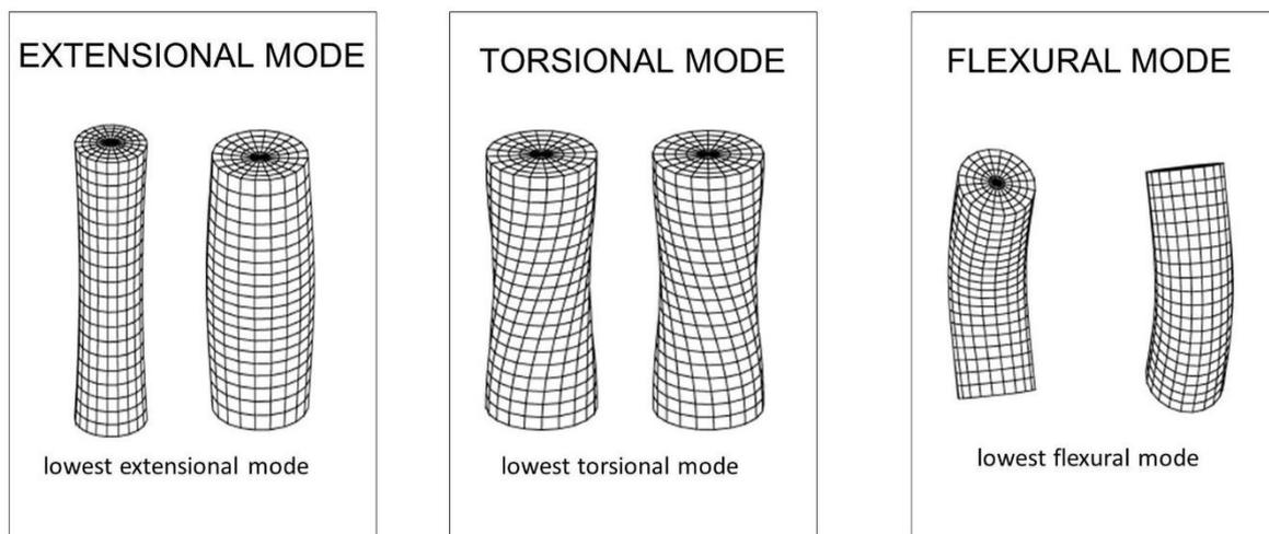
Figure 38 : Déformations correspondant aux trois familles de modes propres de vibration d'un cylindre, à savoir mode d'extension (sous figure de gauche), mode de torsion (sous-figure du centre), et mode de flexion (sous-figure de droite). Seuls les premiers modes sont représentés.
