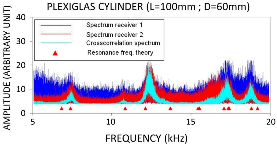
Figure 36 : Même chose qu'en figure 34 mais avec un cylindre de Plexiglas (diamètre  $D=6\text{cm}$  et longueur  $L=10\text{cm}$ ), excepté que  $N_{stack} = 40$ .
