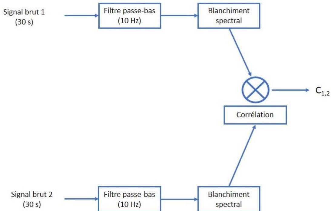
Figure 68 : Séquence de traitements appliqués aux signaux avant et jusqu'à corrélation entre les signaux,  $C_{1,2}$ .
