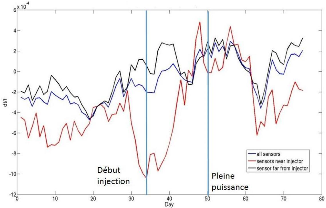
Figure 84 : Variations de  $dt/t$  au fil des jours. En bleu : toutes les paires de capteur, en noir, paires de capteurs situés hors du voisinage du puits d'injection, en rouge, paires de capteurs situés dans le voisinage du puits d'injection. Fenêtre de temps choisie dans les doublets 7-9s. L'injection début au jour 34 pour atteindre la pleine puissance au jour 50.
