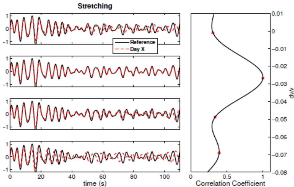
Figure 20 : A gauche : en noir, corrélation de référence, en rouge, corrélation dilatée (« stretchée »). Quatre coefficients  $dv/v$  sont choisis, ce qui correspond aux 4 figures de gauche. Les coefficients de corrélation entre corrélation référence et corrélation dilatée sont reportés sur la courbe de droite. Le deuxième cas est le plus satisfaisant. D'après Hadziioannou 2011
