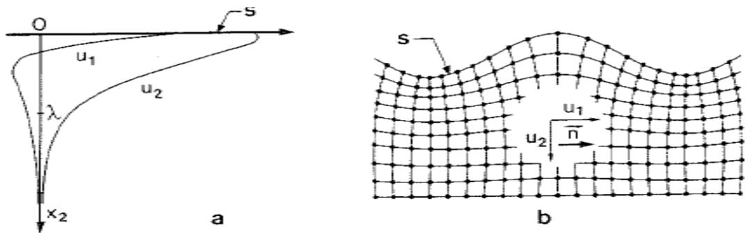
Figure 5 : onde de Rayleigh dans un milieu isotrope semi-infini. Vecteur  $\vec{s}$  : sens de propagation. a) décroissance de la composante longitudinale  $u_1$  et de la composante transversale  $u_2$  en fonction de la profondeur. b) déformation de la surface. (modifié d'après Royer-Dieulesaint 1996)
