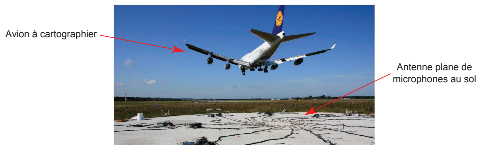
FIGURE 1 – Exemple de configuration expérimentale pour l'étude du bruit de passage d'un avion avec une antenne plane de microphones au sol. Figure extraite de l'article de Siller et al. [Siller 2010].
