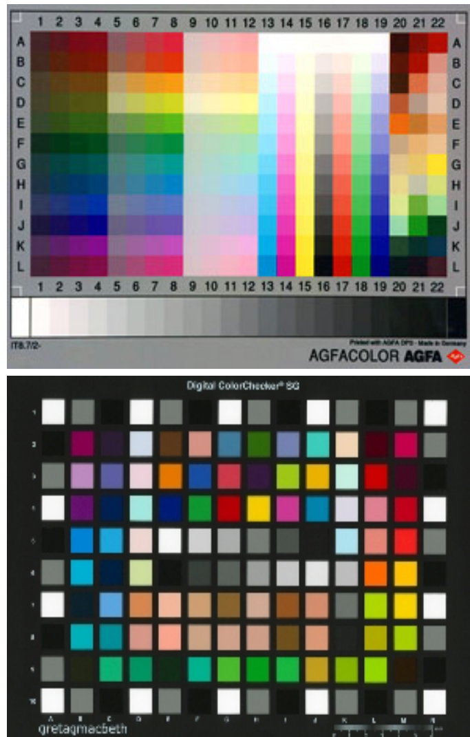
FIGURE 4.18: Deux autres exemples de mières couleur. La mire Agfa it8.7/2 en haut et la mire colorchecker SG en bas.
