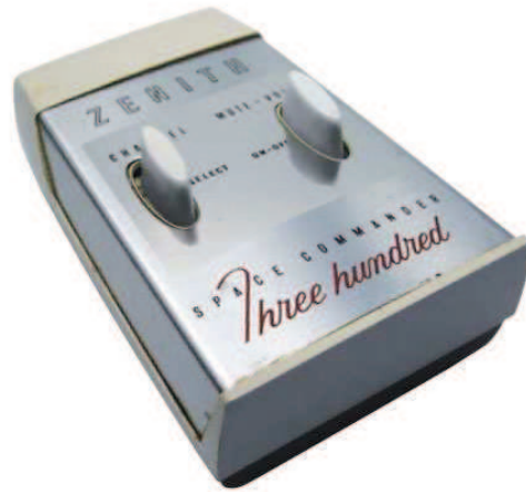
FIGURE 2.1: Zenith Space Command 300, 1956. Deux boutons permettent de contrôler la chaîne et le volume.
