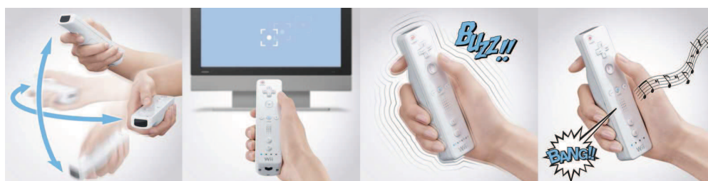
FIGURE 3.5: Un exemple de télécommande augmentée : les possibilités de la Wiimote.
