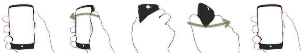
FIGURE 4.9: Combinaison de gestes : L'utilisateur effectue un geste de rotation du téléphone dans un sens. Puis il effectue un geste de rotation dans l'autre sens. Le geste a une signature unique qui permet d'être reconnu sans la nécessité d'utiliser un délimiteur [Ruiz et Li, 2011].
