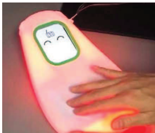
FIGURE 3.11: Rebo : un geste sur le corps de la télécommande permet de changer de chaîne. [Kobayashi et al. , 2009].
