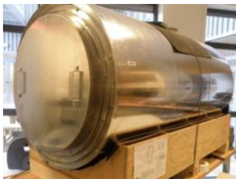
Figure 2.2.2 : Représentation de la chaîne de mesure mise en place. L'observable est ici la pente de résonance obtenue en sortie de la boucle ouverte, i.e. directement en sortie de la détection synchrone. Pour observer cette pente, une rampe de champ externe de +/- 500 nT à 5 Hz de part et d'autre du champ nul est générée suivant l'axe de la mesure. A gauche, photographie de la sonde placée au centre de bobines d'Helmholtz générant les rampes de champ. A droite, exemple de pente de résonance obtenue.
