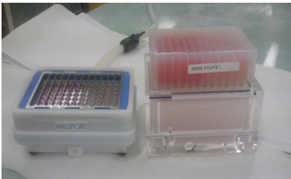
Figure D-1 : photographie des prototypes de microfiltration de première (gauche, Millipore) et seconde génération (droite, Harvard Apparatus). Les capacités volumiques des microplaques filtrantes et réceptrices correspondantes sont de 250µL et 2mL.
