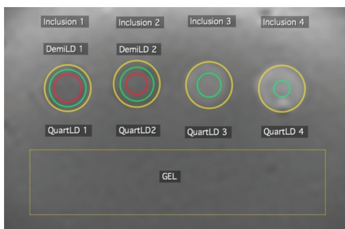
Figure 41: Deux types de ROI sur le fantôme: ROI_Inclusion (en jaune), et ROI_QuartLD (en vert). Les ROI_DemiLD (en rouge) sont exclues car elles ne peuvent pas dessinées sur l'inclusion 3 et 4.
