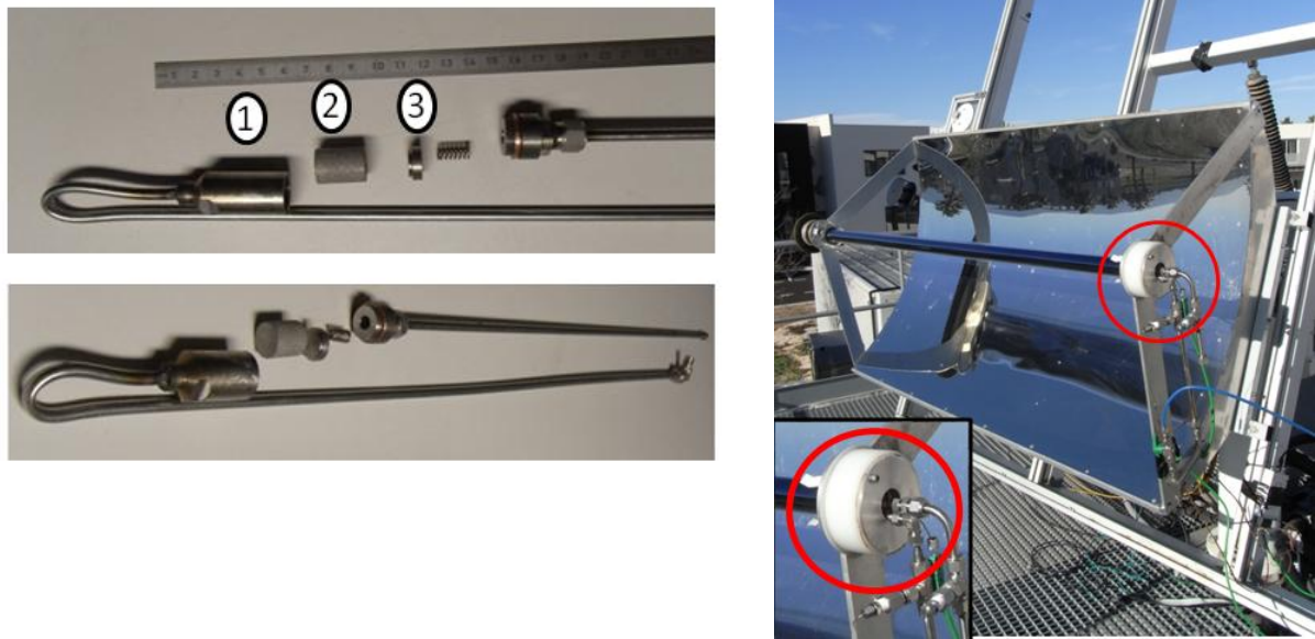
Figure III-16 : Montage de régénération dans le PTC : charbons actifs contenus dans un compartiment (1) avec la cellule frittée de 60 \mu\text{m} (2) et le bouchon (3) et placé dans le tube sous vide
