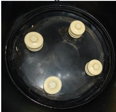
Crépines vissées sur le fond de la colonne
