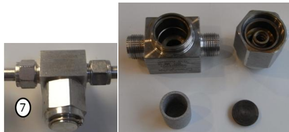
Compartiment contenant les charbons actifs avec la cellule frittée de 60 µm et le bouchon
