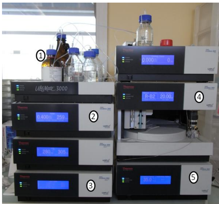
Figure II-4 : HPLC Ultimate 3000 composée des solvants (1), d'une pompe haute pression (2), d'un détecteur UV multi longueurs d'onde (3), d'un plateau d'échantillons avec l'injecteur automatique (4) et d'une colonne de séparation Accucore C18 (5)
