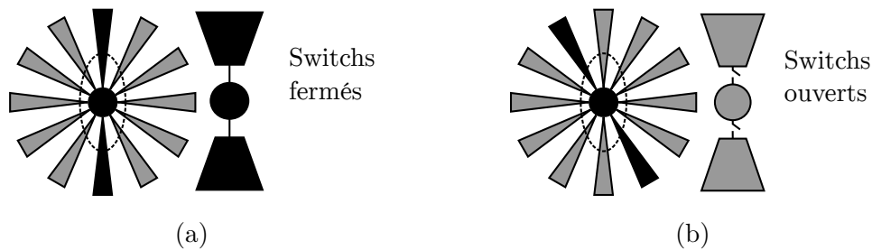
FIGURE 1.12 – Présentation de la cellule utilisée par Girard dans [39]. Le dipôle actif est en noir, les autres sont en gris. Zoom sur un dipôle actif (a) et sur un dipôle inactif (b).
