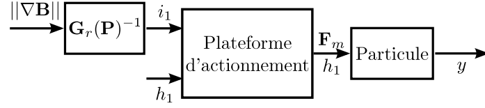
Figure 4.5 - Translation de la particule y produite par \|\nabla\mathbf{B}\| et h_1 en entrée de la plateforme d'actionnement.
