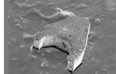
Figure 1.10 - Particule du Mag- \mu Bot : 300 \times 300 \times 100 \mu\text{m}^3 .
