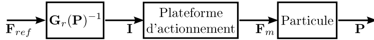
Figure 4.4 - Système en boucle ouverte pour appliquer une force magnétique désirée à la position de la particule.
