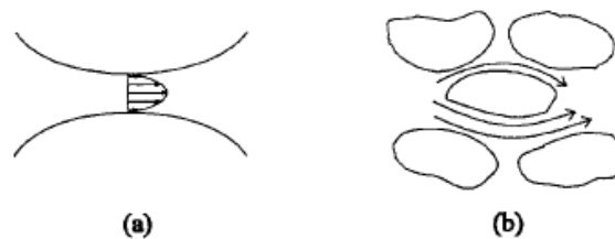
Figura 3 - Mecanismo de dispersão hidrodinâmica em escala microscópica.
