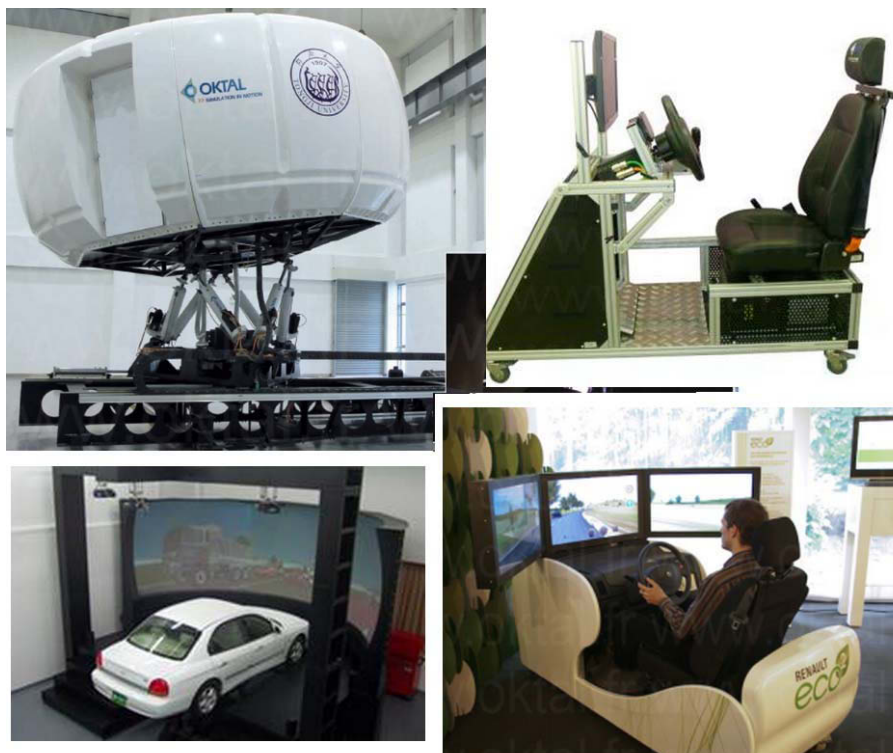
FIGURE A.2 – Différents niveaux de réalisme de postes de pilotage développés par la société Oktal, basés sur le logiciel SCANeR Studio
