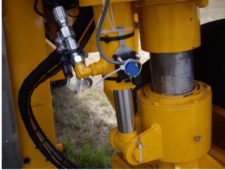
FIGURE 4.6 – Mesure des efforts dans les vérins hydrauliques de suspension
