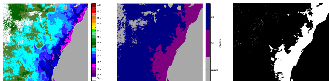
FIGURE 3.16 – Détection automatique de la zone d'upwelling. De gauche à droite : image TSM ; classification sur 2 classes en utilisant la méthode d'Otsu ; seuillage binaire pour la détermination de la zone d'upwelling.
