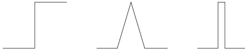
FIGURE 3.2 – Différents types de contours : marche d'escalier, toit et pointe.
