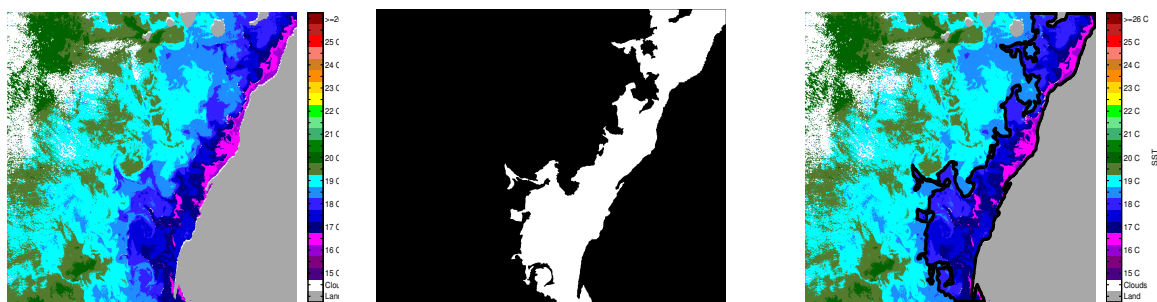
FIGURE 3.17 – Extraction de la zone d'upwelling par l'application de la méthode d'accroissement de région. De gauche à droite : image TSM, extraction de la zone d'upwelling et élimination des structures fines du large, délimitation automatique de la zone d'upwelling.
