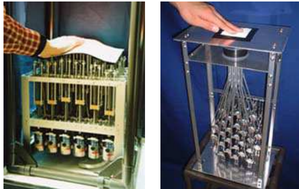
Figure 2.18. Deux réalisations du FEELEX : le FEELEX 1 (1997) avec une surface d'interaction de 24 \times 24 cm (à gauche) ; le FEELEX 2 (2001), avec une surface de 5 \times 5 cm (à droite)
