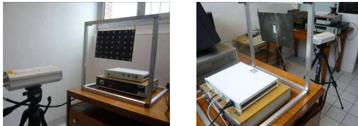
Figure 2. Dispositif expérimental de caractérisation de la plaque.
