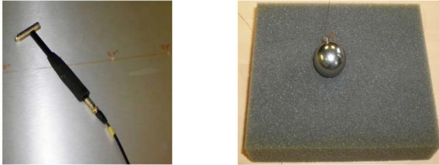
Figure 3-2 : Marteau de choc (à gauche) et bille en acier inoxydable (à droite) utilisés pour générer les excitations transitoires
