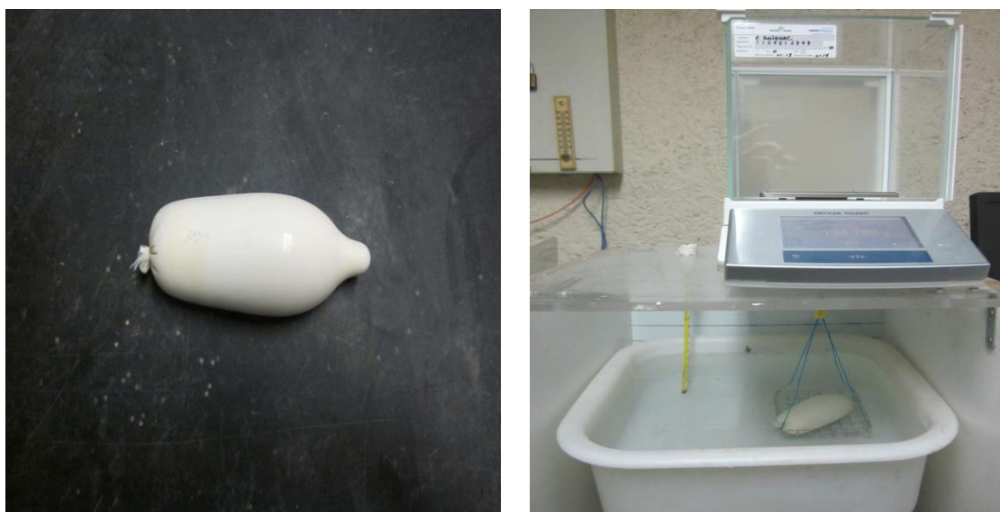
Figure 2.14. Dispositif expérimental de mesure des variations volumiques.
