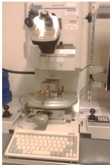
Figure 72 : Machine de cisaillement Dage 4000.
