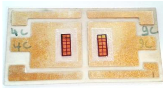
Figure 69 : Puces reportées sur un substrat après le processus du frittage de pâte d'argent.
