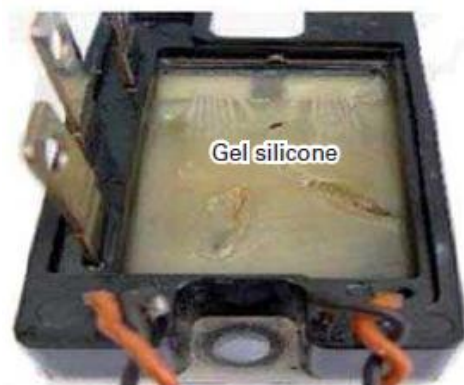
Figure 37 : Module de puissance rempli de gel silicone [49].
