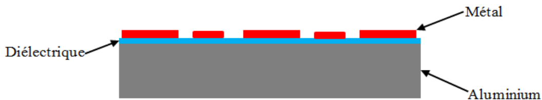
Figure 31 : Schéma d'un substrat métallique isolé (SMI).
