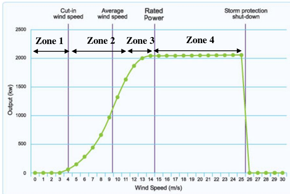
Figure 2.22 : Courbe de puissance d'une éolienne [Partnerships for Renewables]
