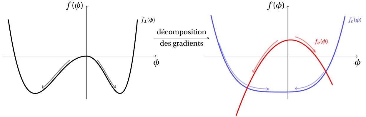
FIGURE 3.1 – Illustration de la méthode de décomposition des gradients. — : fonctionnelle d'énergie libre  $f_{\lambda}$  décomposée en une fonction strictement convexe  $f_c$  (—) associée au flot contractant, et une fonction strictement concave  $f_e$  (—) associée au flot expansif.
