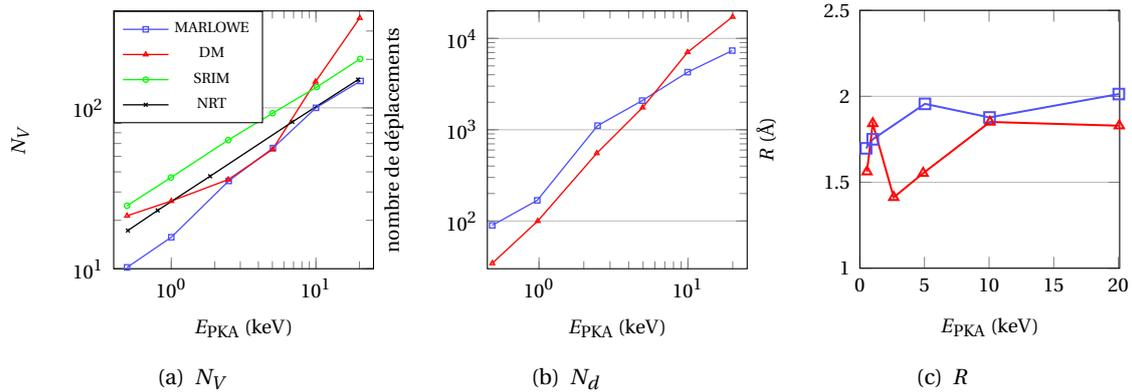
FIGURE C.3 – Nombres de lacunes  $N_V$ , de déplacements  $N_d$  et rayon d'irradiation  $R$  pour Cu : comparaison entre des résultats de dynamique moléculaire<sup>1</sup> (—), de notre étude MARLOWE (moyenne sur 2000 tirs, —), de SRIM (moyenne sur 2000 tirs, —) et du modèle NRT<sup>2</sup> pour  $N_V$  (—).
