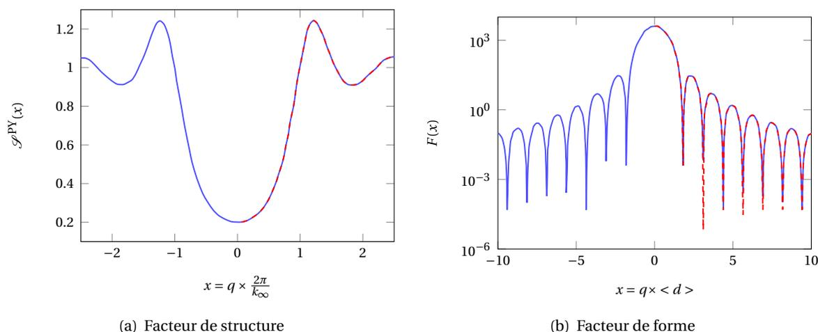
FIGURE 5.9 – À gauche : facteur de structure  $\mathcal{S}^{PY}(x)$  obtenu par transformée de Fourier d'une fonction de Perkus-Yevick (ajustement de la distribution radiale des centres des précipités de cuivre), et facteur de forme  $F(x)$  associé à un précipité sphérique, utilisés pour réaliser les simulations GISAXS.
