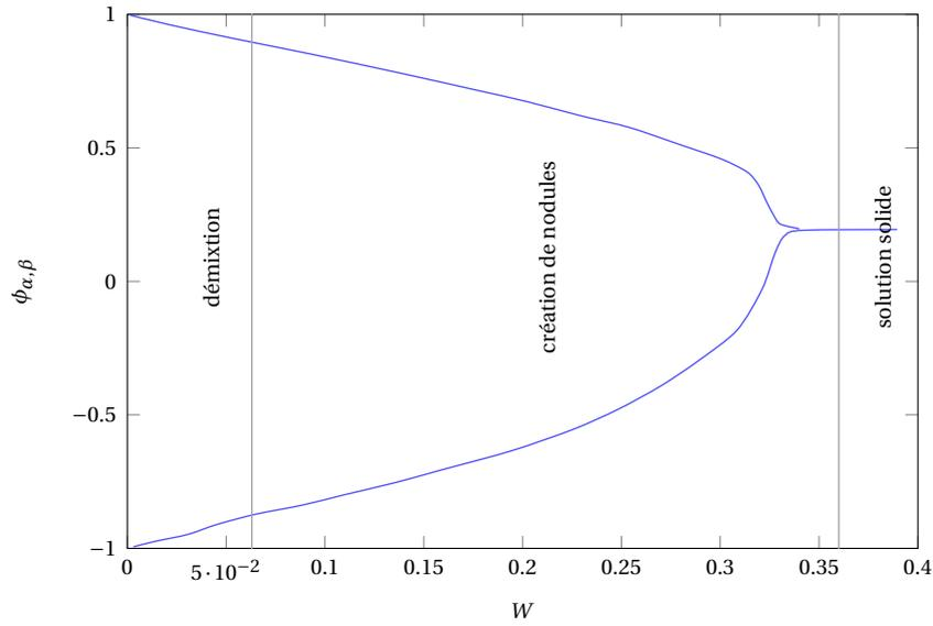
FIGURE 3.23 – Limites de solubilité  $\phi_\alpha$  et  $\phi_\beta$  en fonction de  $W$ , obtenues par simulations numériques dans les trois domaines du pseudo-diagramme de phase, pour  $R = 2$ ,  $\lambda = 0$  et  $\bar{\phi} = 0.2$ . Simulations effectuées avec  $\Delta t = 0.05$ ,  $\Delta x = 0.5$ , un temps final  $t = 10000$ .
