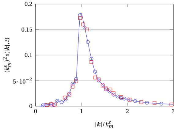
FIGURE 3.14 – Loi universelle vérifiée par le facteur de structure  $(k_m^\epsilon)^2(t)S(|\mathbf{k}|, t) / \|S(\cdot, t)\|_1 = F(|\mathbf{k}|/k_m^\epsilon)$  pour  $\epsilon = 0.5$ , à deux temps différents sous irradiation (cas 2). Simulations réalisées avec  $\Delta x = 0.5$  et  $\Delta t = 0.001$ . Résultats moyennés sur 50 tirs (conditions initiales homogènes telle que  $\bar{\phi} = 0$ ).
