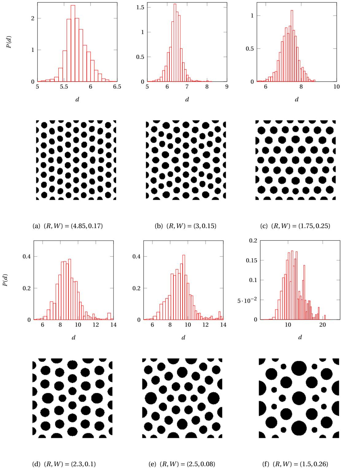
FIGURE 3.28 – Distribution  $P(d)$  des tailles d'agrégats  $d$  (histogrammes rouges) dans le domaine de création de nodules pour différents couples  $(R, W)$ . Pour chaque distribution, un exemple de microstructure est présenté. Simulations effectuées avec  $\lambda = 0.25$ ,  $\bar{\phi} = 0$ ,  $\Delta t = 0.05$ ,  $\Delta x = 0.5$ , un temps final  $t = 5000$ , sur un échantillon de 160 images de microstructure.
