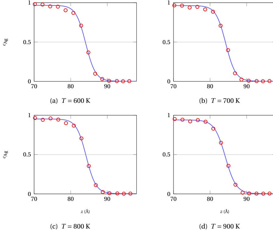
FIGURE 4.6 – Ajustements ( $\rho \sim 0.9995$ ,  $\sigma = 0.001$ ) du profil interfacique pour la concentration en argent, par un sinus elliptique de Jacobi de constante de forme optimale  $p = 0.989$  (—) sur les simulations Monte Carlo Metropolis ( $\circ$ ), pour  $T = 600$  K (en haut à gauche),  $T = 700$  K (en haut à droite),  $T = 800$  K (en bas à gauche) et  $T = 900$  K (en bas à droite).
