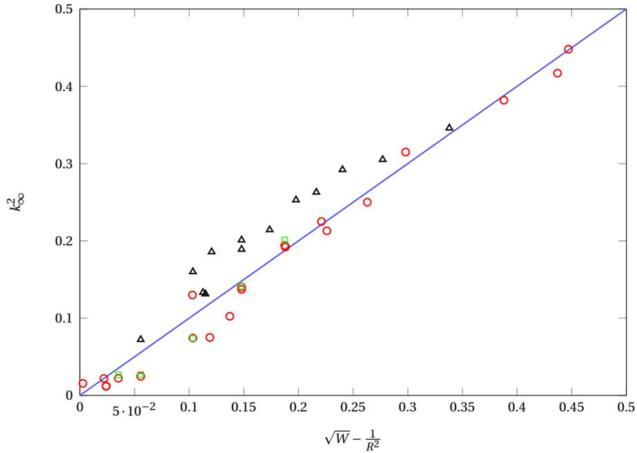
FIGURE 3.21 – Échelle spatiale en temps long  $k_\infty^2$  dans le domaine de création de nodules. Comparaison entre la loi obtenue dans l'approche autocohérente :  $k_\infty^2 = \sqrt{W} - 1/R^2$  (—), et les simulations numériques pour  $\lambda = 0$  (○),  $\lambda = 0.1$  (□) et  $\lambda = 0.25$  (△). Simulations effectuées pour  $\bar{\phi} = 0$ , avec  $\Delta t = 0.05$ ,  $\Delta x = 0.5$ , un temps final  $t = 10000$ , moyenne sur 50 tirs.
