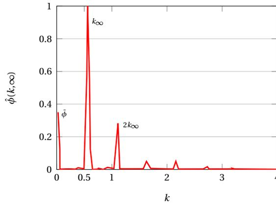
FIGURE 3.25 – Fonction  $\hat{\phi}(|\mathbf{k}|, t \rightarrow \infty)$  (temps longs) dans le domaine de création de nodules : solution numérique dans le domaine de Fourier, pour  $\lambda = 0$ ,  $R = 2$ ,  $W = 0.15$  et  $\bar{\phi} = 0.2$ . Simulation effectuée pour  $\Delta t = 0.05$ ,  $\Delta x = 0.5$  et un temps final  $t = 10000$ . Les harmoniques  $2k_\infty$ ,  $3k_\infty$  et  $4k_\infty$  sont représentées.
