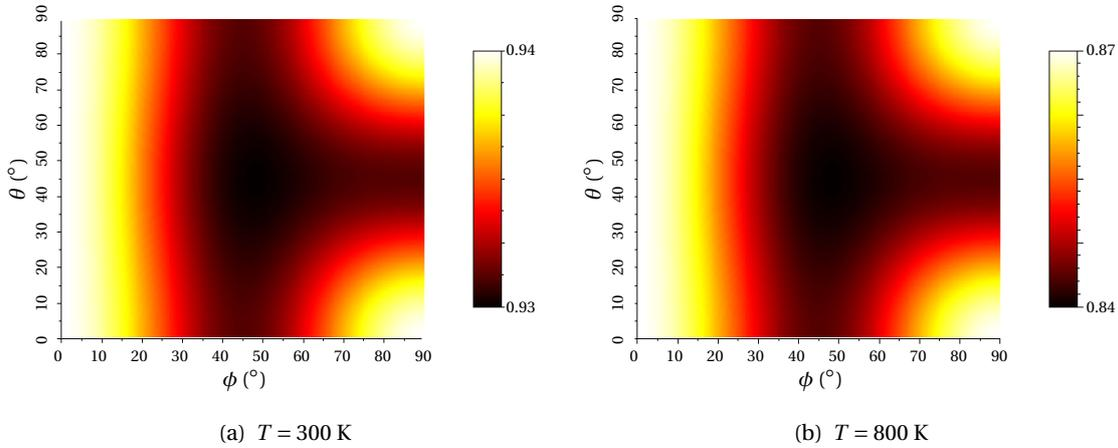
FIGURE 4.8 – Surface d'isovaleurs de l'énergie élastique  $\langle \Delta E_{el} \rangle$ , calculée en fonction de  $\theta$  et  $\phi$  pour une concentration moyenne de 0.5 en argent. À gauche :  $T = 300\text{ K}$ , à droite  $T = 800\text{ K}$ .
