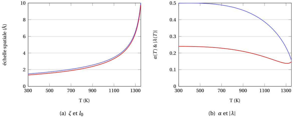
FIGURE 4.12 – À gauche : échelles spatiales  $l_0$  (courbe rouge  $\rightarrow$ ) et  $\xi$  (courbe bleue  $\rightarrow$ ). À droite : paramètres adimensionnels  $\alpha$  (courbe bleue  $\rightarrow$ ) et  $\lambda$  (courbe rouge  $\rightarrow$ ), en fonction de la température  $T$  pour AgCu.
