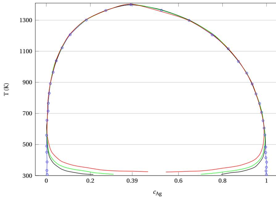
FIGURE 5.4 – Diagramme de phase de l'alliage AgCu dans le plan  $(\Phi, T)$  hors irradiation ( $\circ$ ) et pour différents flux d'irradiation aux ions Kr (1 MeV) :  $\Phi = 1.21 \times 10^{13} \text{ cm}^{-2}\text{s}^{-1}$  (—),  $\Phi = 2.42 \times 10^{13} \text{ cm}^{-2}\text{s}^{-1}$  (—) et  $\Phi = 1.21 \times 10^{14} \text{ cm}^{-2}\text{s}^{-1}$  (—).
