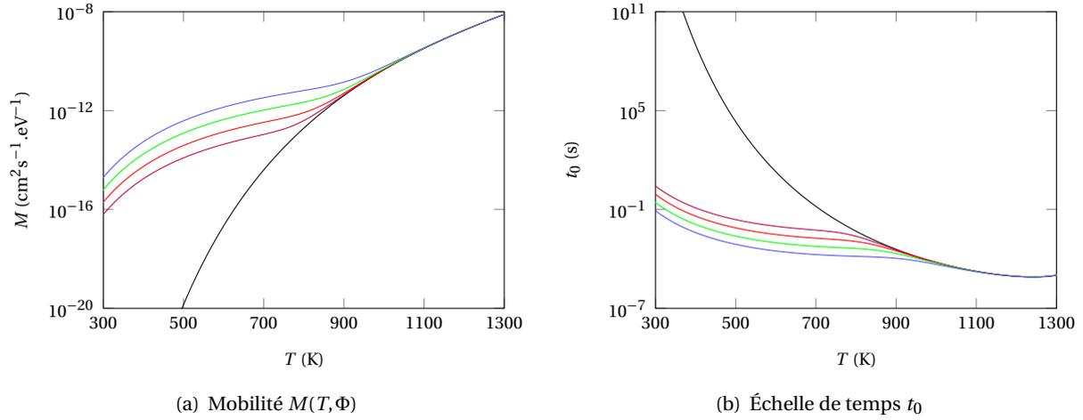
FIGURE 4.13 – À gauche : mobilité sous irradiation  $M(T, \Phi)$  en fonction de la température pour différents flux :  $\Phi = 0$  (—),  $\Phi = 10^{10}$  (—),  $\Phi = 10^{11}$  (—),  $\Phi = 10^{12}$  (—), et  $\Phi = 10^{13}$  (—)  $\text{cm}^{-2} \cdot \text{s}^{-1}$  d'ions Kr (1 MeV), et comparaison avec la mobilité hors irradiation  $M^{th}$  (—). À droite : échelle de temps  $t_0$  définie par la mobilité sous irradiation, pour les mêmes flux.
