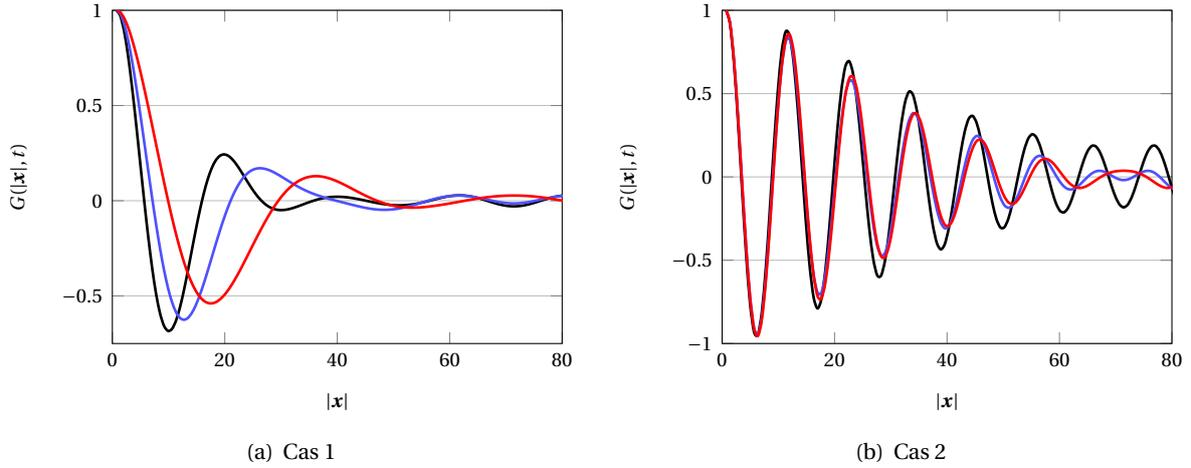
FIGURE 3.6 – Fonction de corrélation  $G(|\mathbf{x}|, t)$  dans les cas 1  $(\lambda, R, W) = (0, 0, 0)$  (à gauche) et 2  $(\lambda, R, W) = (0.2, 3, 0.2)$  (à droite), aux instants  $t = 200$  (—),  $t = 400$  (—) et  $t = 1000$  (—). Simulations réalisées avec  $\Delta x = 0.5$  et  $\Delta t = 0.05$  et des conditions initiales aléatoires homogènes telles que  $\bar{\phi} = 0$ . Moyenne sur 50 tirs.
