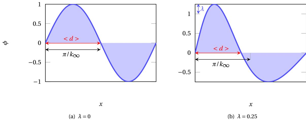
FIGURE 3.30 – Schéma illustrant l'écart potentiel entre la taille  $\langle d \rangle$  du nodule de gauche, et l'estimation  $\pi/k_\infty$  de cette longueur lorsque  $\lambda < 0$ , en dimension 1. À gauche :  $\lambda = 0$  et  $\langle d \rangle = \pi/k_\infty$ . À droite :  $\lambda = 0.25$  et  $\pi/k_\infty < \langle d \rangle$ .
