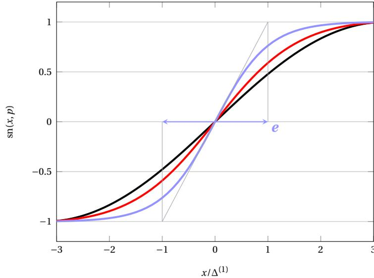
FIGURE 2.4 – Profil d'interface en sinus elliptique de Jacobi  $\text{sn}(\cdot, p)$ , pour trois valeurs du paramètre  $p$ . — :  $p \approx 0$  (profil proche du sinus). — :  $p = 0.7$  (profil intermédiaire entre le sinus et la tangente hyperbolique). — :  $p = 1$  (profil en tangente hyperbolique).  $e$  est l'épaisseur de l'interface associée à  $p = 1$ .
