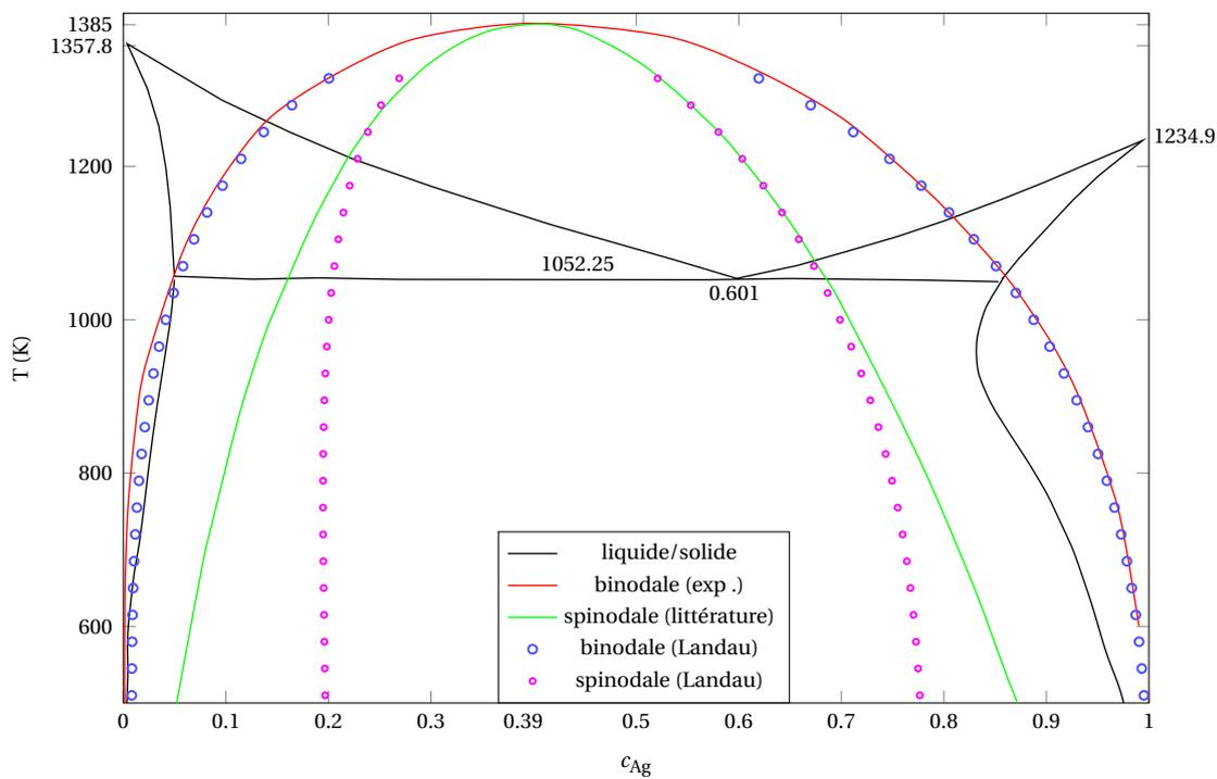
FIGURE 4.2 – Diagramme de phase expérimental pour l'alliage AgCu dans le plan  $(c_{Ag}, T)$ . Le diagramme est asymétrique en accord avec une transition de phase du premier ordre. — : courbe binodale fixant les limites de solubilité. — : spinodale délimitant la zone métastable de la zone instable. L'ajustement des coefficients de Landau fournit la courbe binodale de Landau (○) et la courbe spinodale (○).  $c_c = 0.39$  et  $T_c \sim 1385$  K.
