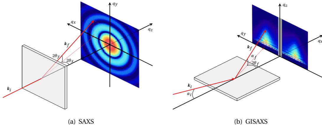
FIGURE 5.5 – Montages SAXS (gauche) et GISAXS (droite). Le faisceau incident d'intensité  $I_0$  diffracte dans le matériau. Le signal diffracté est collecté par un détecteur 2D.
