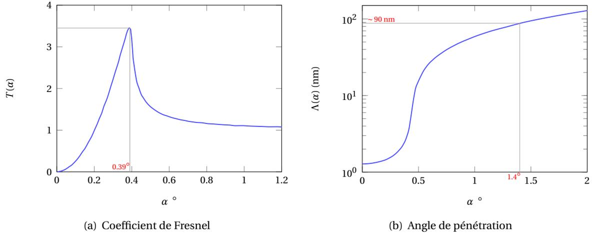
FIGURE 5.6 – Coefficient de Fresnel  $T(\alpha)$  (à gauche) et profondeur de pénétration  $\Lambda(\alpha)$  (à droite) obtenus pour AgCu en utilisant les données du tableau 5.2.  $\alpha_c = 0.39^\circ$ . Pour  $\Lambda(\alpha_i) = 90 \text{ nm}$ ,  $\alpha_i = 1.4^\circ \neq 1 - 2\alpha_c$ .
