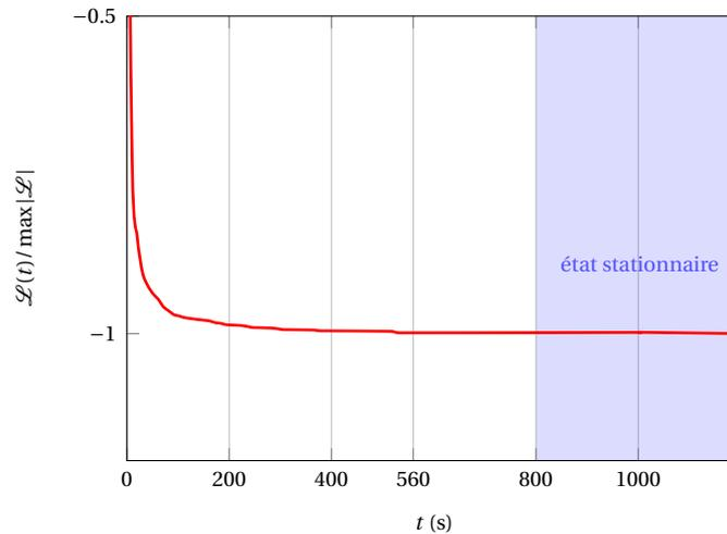
FIGURE 5.3 – Fonctionnelle de Lyapunov normalisée  $\mathcal{L}(t)/\max|\mathcal{L}|$  (—) à  $T = 320$  K, en fonction du temps réel, pour le système AgCu de concentration moyenne  $\bar{c} = 0.6$  en argent, soumis à un flux  $\Phi = 5 \times 10^{12} \text{ cm}^{-2} \text{ s}^{-1}$  d'ions Kr (1 MeV), et temps nécessaire pour atteindre l'état stationnaire (pour un exemple de condition initiale aléatoire) dans le domaine de création de nodules.
