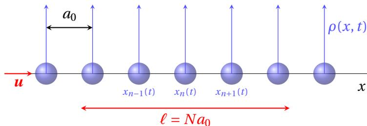
FIGURE 2.1 – Représentation schématique en dimension 1 d'un cristal, selon le vecteur unitaire  $\mathbf{u}$ . Les atomes sont disposés en  $x_n(t) = na_0 + u(t)$  (tel que  $|u(t)| \ll 1$  et  $\langle x_n(t) \rangle = na_0$ ). La densité de présence des atomes  $\rho(x, t)$  est modélisée par un peigne de Dirac à une température  $T = 0$  K.  $\ell = Na_0$  est la taille d'une cellule mésoscopique.
