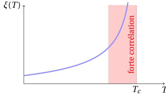
FIGURE 2.3 – Longueur de corrélation  $\xi(T) \sim (T_c - T)^{-1/2}$  en fonction de la température  $T$ . Lorsque  $T \rightarrow T_c$ ,  $\xi(T) \rightarrow \infty$  : le système devient fortement corrélé et l'approche de Landau-Ginzburg n'est plus valide.
