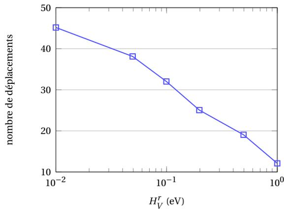
FIGURE C.2 – Étude de l'influence du paramètre  $H_V^r$  sur le nombre de déplacements au sein d'une séquence de collision linéaire à très faible énergie incidente ( $E_{\text{PKA}} = 25$  eV) dans la direction cristallographique  $\langle 011 \rangle$ .
