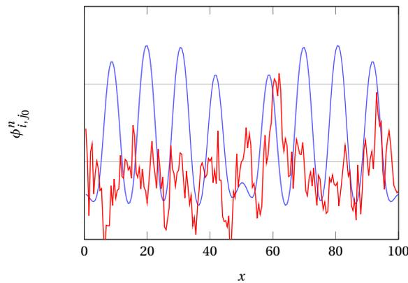
FIGURE 3.13 – Diminution de l'amplitude des solutions due au bruit : coupe des solutions  $(\phi_k^n)$  (associées à la figure 3.12) pour  $\epsilon = 0$  (—) et  $\epsilon = 0.5$  (—). Simulations réalisées avec  $\Delta x = 0.5$  et  $\Delta t = 0.001$  pour un temps final  $t = 1000$ , pour la même condition initiale homogène telle que  $\bar{\phi} = 0$ .
