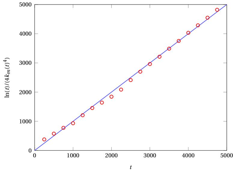
FIGURE 3.22 – Cinétique de grossissement obtenue par l'approche autocohérente :  $k_m(t) \sim (\ln(t)/(4t))^{1/4}$  (—) et comparaison avec des simulations numériques (○), pour  $\lambda = 0.25$ , hors irradiation. Simulations numériques effectuées pour  $\bar{\phi} = 0$ , avec  $\Delta t = 0.05$ ,  $\Delta x = 0.5$ , pour  $t_f = 5000$ , moyenne sur 50 tirs. Corrélation entre les courbes numérique et analytique :  $\rho = 0.9986$ .
