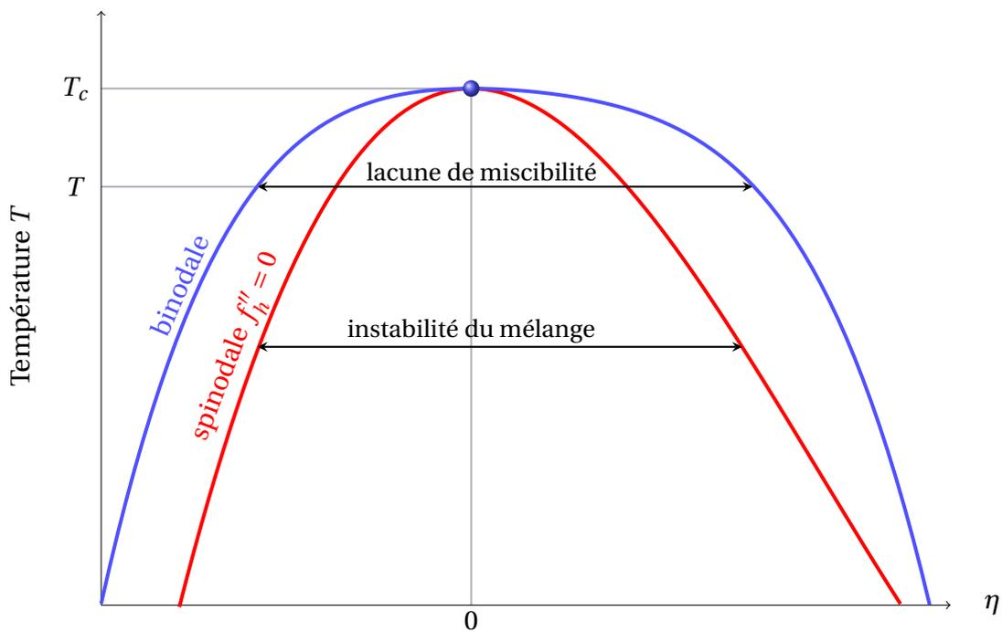
FIGURE 2.5 – Diagramme de phase dans le plan  $(\eta, T)$  pour un alliage binaire AB de type AgCu. — : courbe binodale séparant les phases homogène et hétérogène. — : courbe spinodale ( $f_h'' = 0$ ) séparant la zone d'instabilité et la zone métastable de nucléation-croissance. Les courbes sont confondues au point critique  $(0, T_c)$ .
