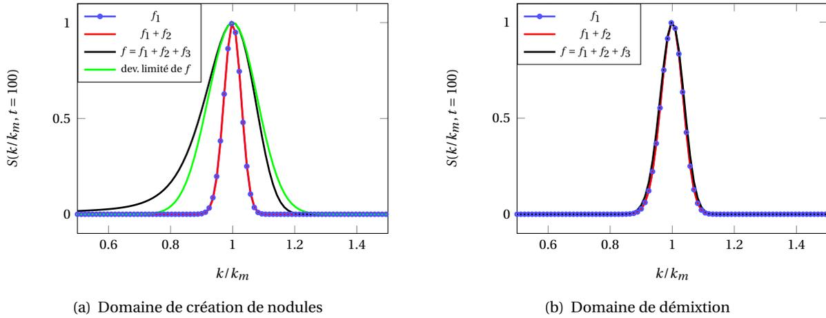
FIGURE B.3 –  $\exp[-2tk_m^A f(\theta, k/k_m)]$ , pour  $k_m = 0.5$  (—) dans les domaines de création de nodules (gauche) et de démixtion (droite), pour  $t = 100$  et  $k/k_m \geq 0.4$ , et comparaison avec  $\exp[-tf_1(\theta, k/k_m)]$  (○) et  $\exp[-2tk_m^A(f_1 + f_2)(\theta, k/k_m)]$  (—). Dans le cas du domaine de création de nodules (gauche), le développement limité au plus bas ordre de  $f$  selon  $k/k_m$  autour de 1 (—) fournit une approximation satisfaisante du facteur de structure.
