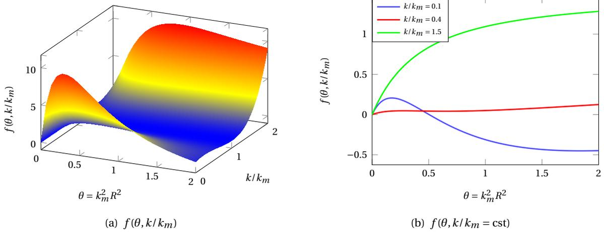
FIGURE B.1 –  $f(\theta, k/k_m)$  dans le domaines de création de nodules en fonction de  $\theta$  et  $k/k_m$  (gauche) et coupe pour différentes valeurs de  $k/k_m$  (droite). Pour  $k/k_m = 0.1$  (—),  $f(\theta, k/k_m) < 0$  (pour  $\theta \geq 0.5$ ). Pour  $k/k_m = 0.4$  (—) et  $k/k_m = 1.5$  (—),  $f(\theta) \geq 0$  comme attendu.
