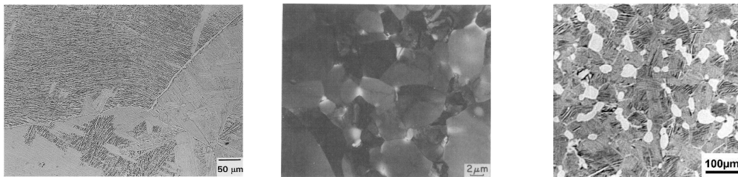
(a) Structure lamellaire [SESHACHARYULU et collab., 2000a] (b) Structure équiaxe [FOLLANSBEE et GRAY, 1989] (c) Structure bimodale [LÜTJERING et WILLIAMS, 2007]
