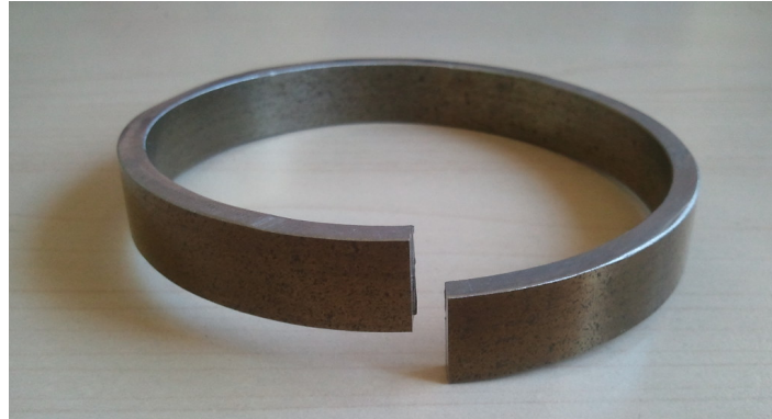
FIGURE 2.11 – Illustration de l’effet d’ouverture constaté lors d’une découpe longitudinale d’un anneau prélevé dans le tube B, du fait des contraintes résiduelles. L’épaisseur du trait de coupe a été évaluée à 330\ \mu\text{m} .
