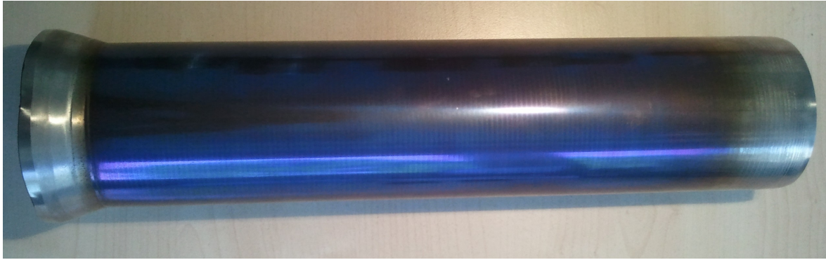
FIGURE 2.2 – Photographie d'un tube fluotourné par Roxel (nuance ELI, 60 % de réduction d'épaisseur en une passe). Le talon (à gauche) est dû aux cônes d'attaque des différentes molettes.
