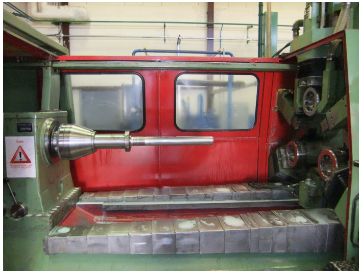
(a) Photographie du fluotour industriel, illustrant le mandrin (au centre) et les trois molettes (à droite).
