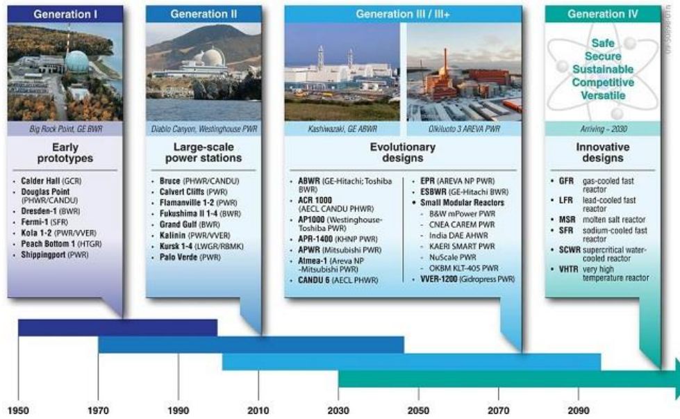
Figure 1.1 : Calendrier des réacteurs nucléaires en termes de génération [7].
