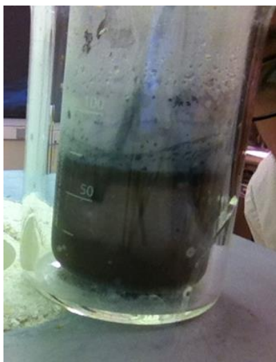
Figure 1.17 Photographie du mélange LiCl-KCl (59-41 mol%) en présence d'UCl 3 (0,015 mol.kg -1 ) produit par électrolyse d'uranium métal à 500°C après deux jours de repos.
