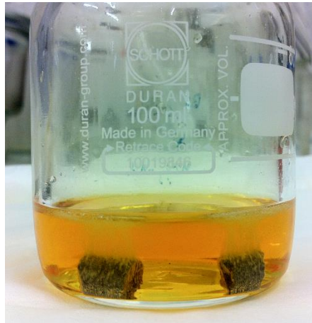
Figure 2.6 : Mise en solution d'un échantillon de bismuth lithié.
