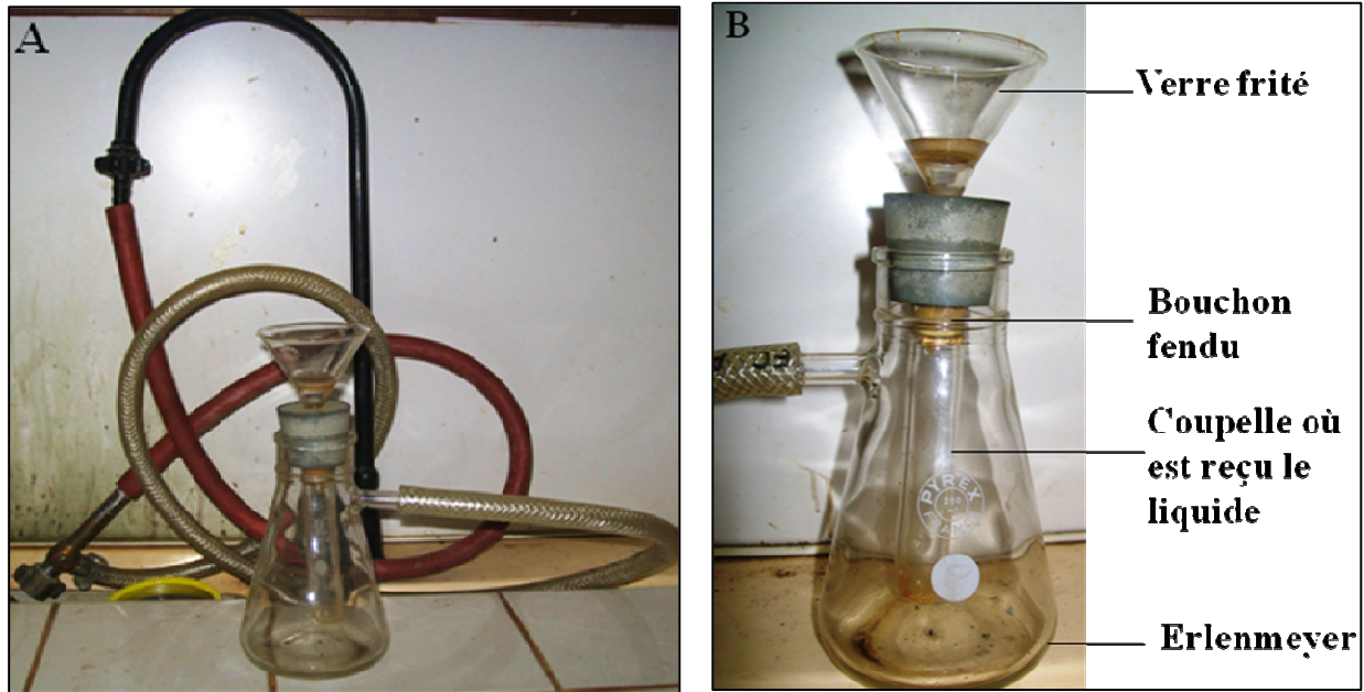
Figure 15 : Photographies de l'appareillage d'extraction et de recueillement du liquide digestif des oligochètes.
