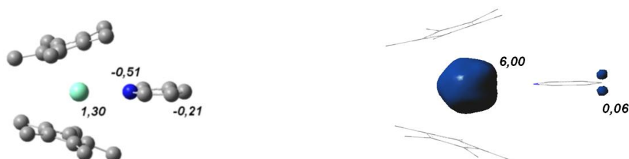
Figure IV-6. Charges NPA (à gauche) et densité de spin de Mulliken (à droite) calculées pour \text{Cp}^*_2\text{Sm}(\text{py}) . Les atomes d'hydrogène ont été omis pour des raisons de clarté.
