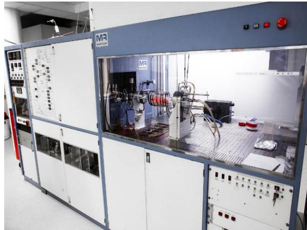
Figure 2.1.2 : Bâti de croissance MOCVD au GEMaC (le bâti 'SAT').
