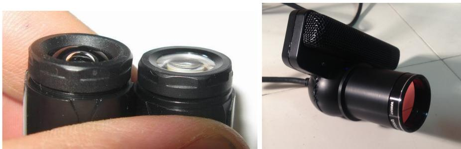
FIGURE 4.7 : Le capteur PS3Eye modifié et personnalisé en ajoutant un lentille télescopique
