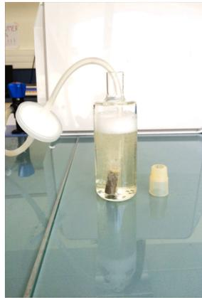
**Figure 29: Saturation des fermenteurs en CO<sub>2</sub>**
