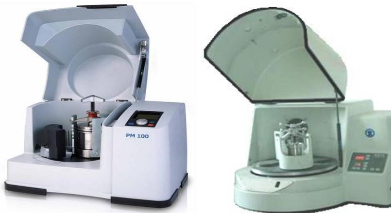
*Figure II.5.a- Broyeur planétaire type RETSCH PM100 utilisé au LCPM (Liban) ; b- Broyeur planétaire type FRITSCH pulverisette 5 utilisé à l'ICMCB (France)*
