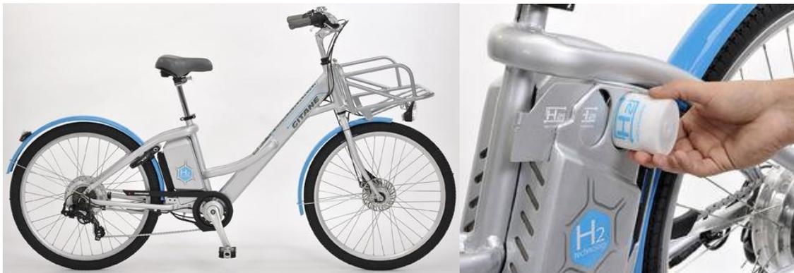
*Figure I.7. Le vélo " ALTER BIKE" et la cartouche de l'hydrogène*
