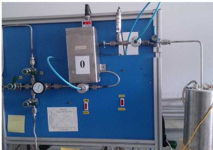
*Figure II.11. Appareillage utilisé pour l'hydruration de petites quantités de matière*
