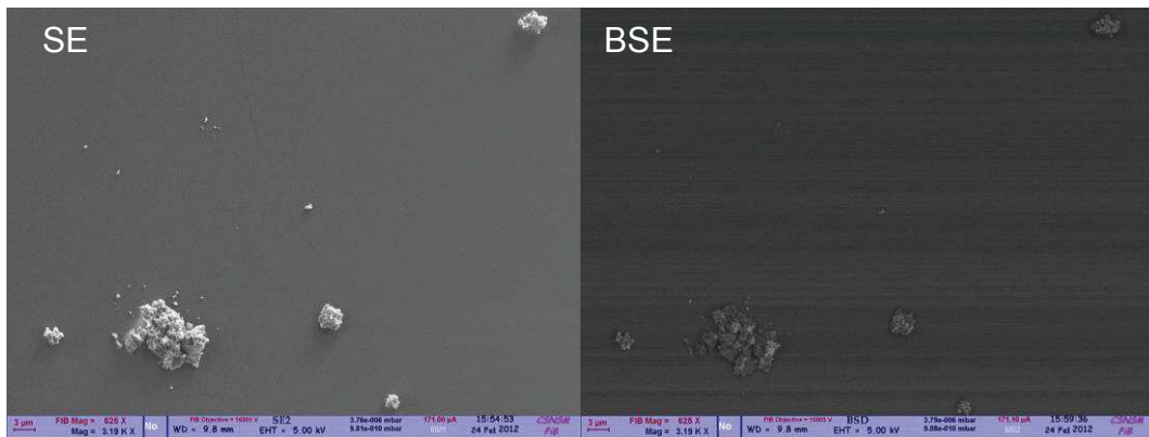
Figure 8-10. Images en SE (à gauche) et BSE (à droite) du fragment de la particule DC43 monté sur la cellule diamant (#12_bottom).
