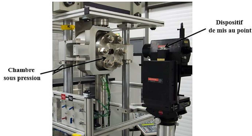
Figure B-2 : Visualisation du dispositif Hycomat
