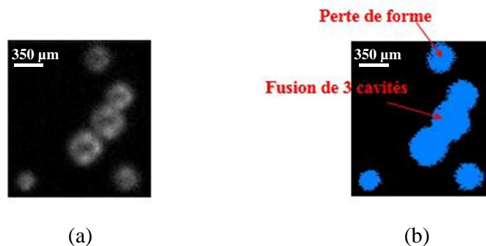
Figure B-8 : Principe d'une binarisation d'images avec (a) Image brute obtenue après l'étape de soustraction avec 6 cavités visibles et (b) Etape de binarisation avec perte de forme pour certaines cavités et fusion pour d'autres
