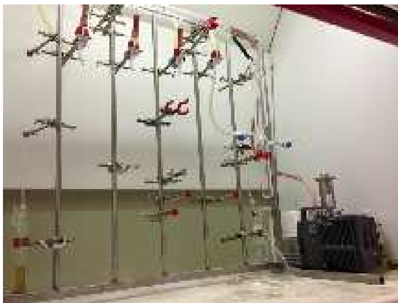
Figure A.3 : Photographie du montage pour la synthèse du N_2O_5 .
