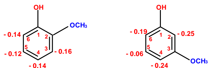
Figure III.21. Calcul de densité électronique du guaiacol (à gauche) et 3-MP (à droite).
