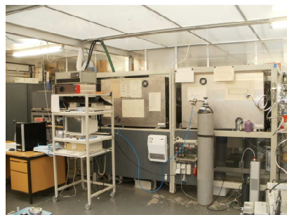
Figure IV.4. Photographies de la chambre de simulation atmosphérique de 480 L de l'Université de Wuppertal (l'extérieur, à gauche et l'intérieur, à droite).
