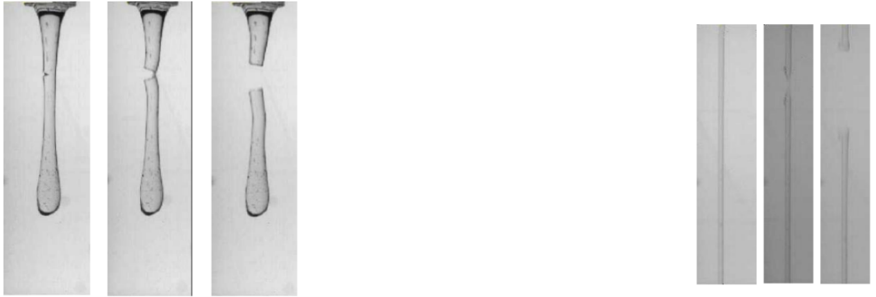
FIGURE 6.10 – Expériences de gouttes pendantes réalisées dans les mêmes conditions (diamètre d'ouverture de 8 mm) pour deux fluides viscoélastiques de Maxwell ayant les mêmes propriétés rhéologiques linéaires (modules de cisaillement et temps de relaxation identiques) : microémulsion connectée à gauche et solution de micelles géantes à droite. Une fracture apparaît dans les deux cas. Le diamètre du filament de micelles géantes est plus petit car la fracture se développe bien plus bas. Les formes sont différentes : cassure nette à gauche, cassure plus « filamenteuse » à droite.
