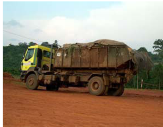
B. Départ d'un Ampliroll à la décharge
