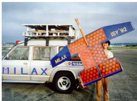
Figure 1-23 Pilotage d'un avion alimenté par l'énergie RF ( F_{req}= 2.411 GHz) [Mats02]
