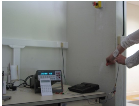
Figure 4-36 Banc de test: rectenna sur le corps pour l'alimentation d'une calculatrice.
