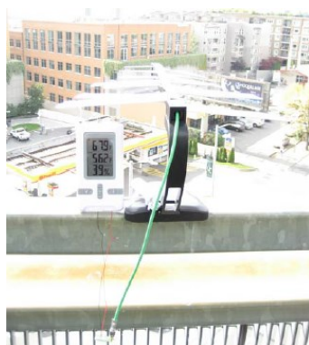
Figure 1-24 Récupération d'énergie RF ambiante pour l'alimentation d'un thermomètre [SaSm09].
