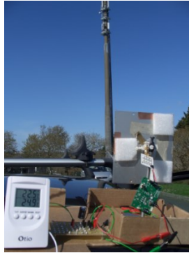
Figure 3-46 Thermomètre alimenté par la rectenna placée à 50 m d'une antenne GSM1800 et UMTS.
