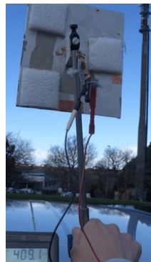
Figure 3-43 Photo de la mesure de la rectenna en environnement extérieur.
