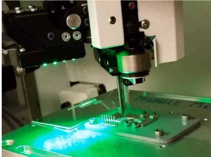
Fig. II-16 : Câblage des fils par Wire Bonder
