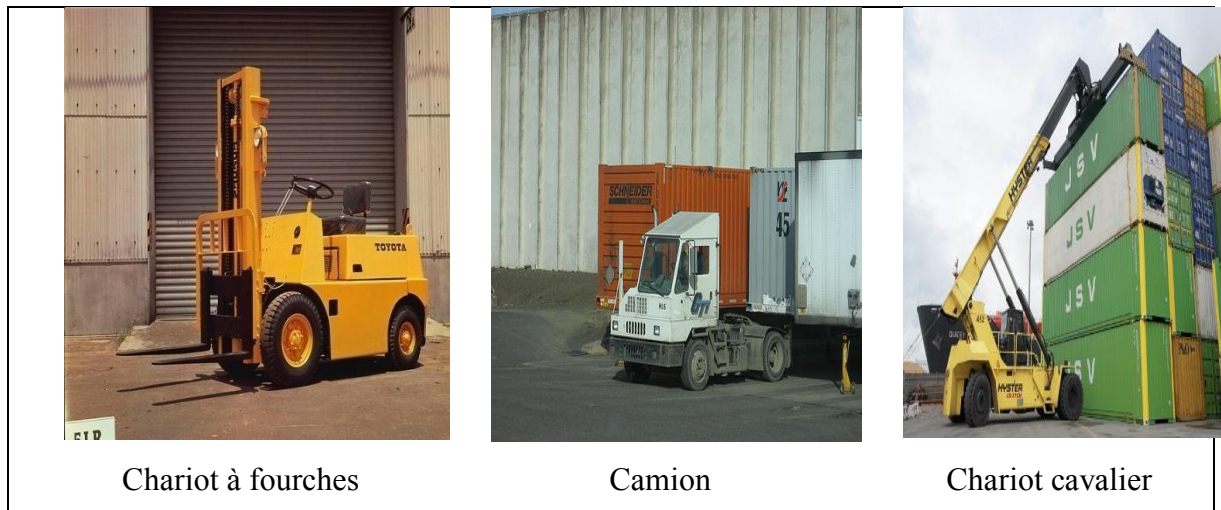
Figure 1.11. Équipements de manutention
