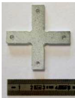
Figure 35. Echantillon cruciforme de films de PDMS, recouvert d'un mouchetis de peinture grise.
