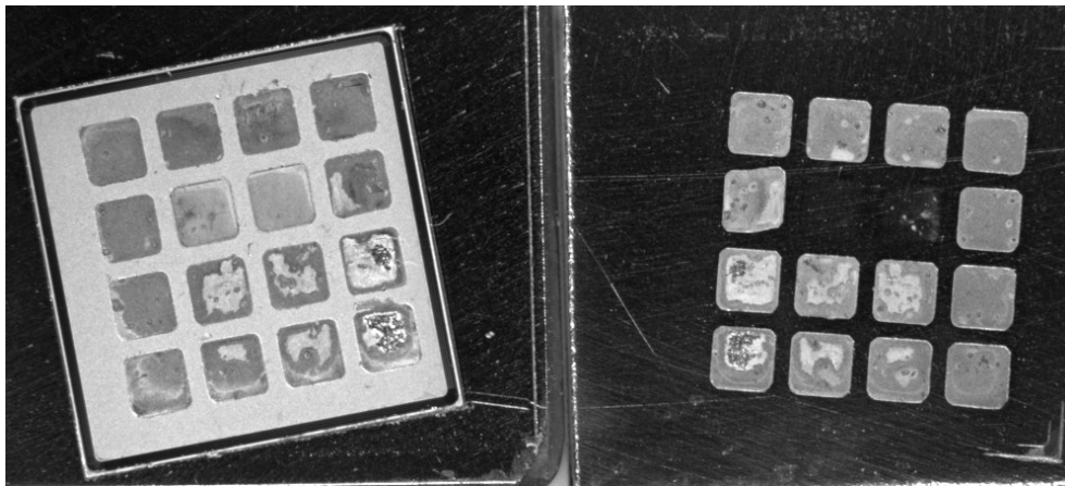
FIGURE 6.28 – faciès de rupture d'un assemblage puce/DBC après essai de cisaillement, montrant que la plupart du temps, la rupture ne se produit pas à l'interface micropoteaux/DBC.
