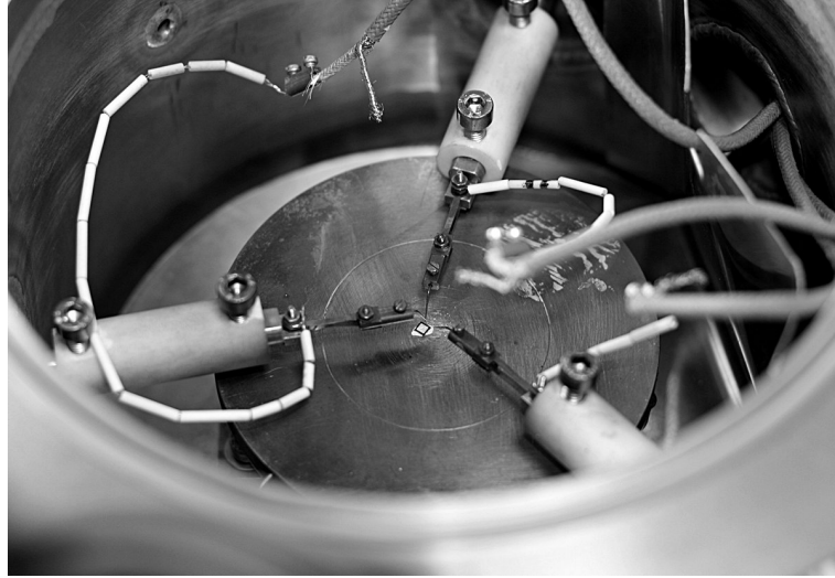
FIGURE 7.3 – Dispositif de caractérisation sous vide, permettant de chauffer une puce nue et de venir prendre des contacts à l'aide de micromanipulateurs équipés de pointes. La diode MPS sous test est visible au centre de l'image.
