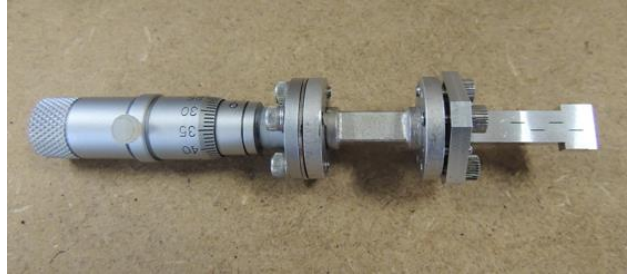
Figure 5.38. Capteur MMID formé par l'antenne GORF et le CCC.
