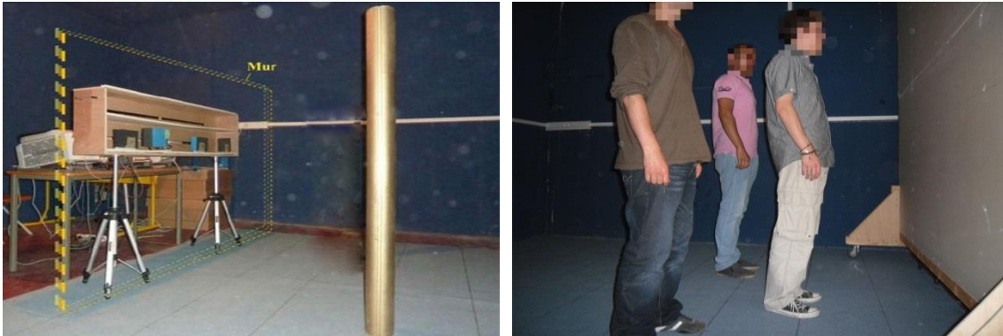
Figure 4.13 : photographie de la scène réelle de mesures pour le radar pulsé avec différents types de cibles (métalliques et humaines).
