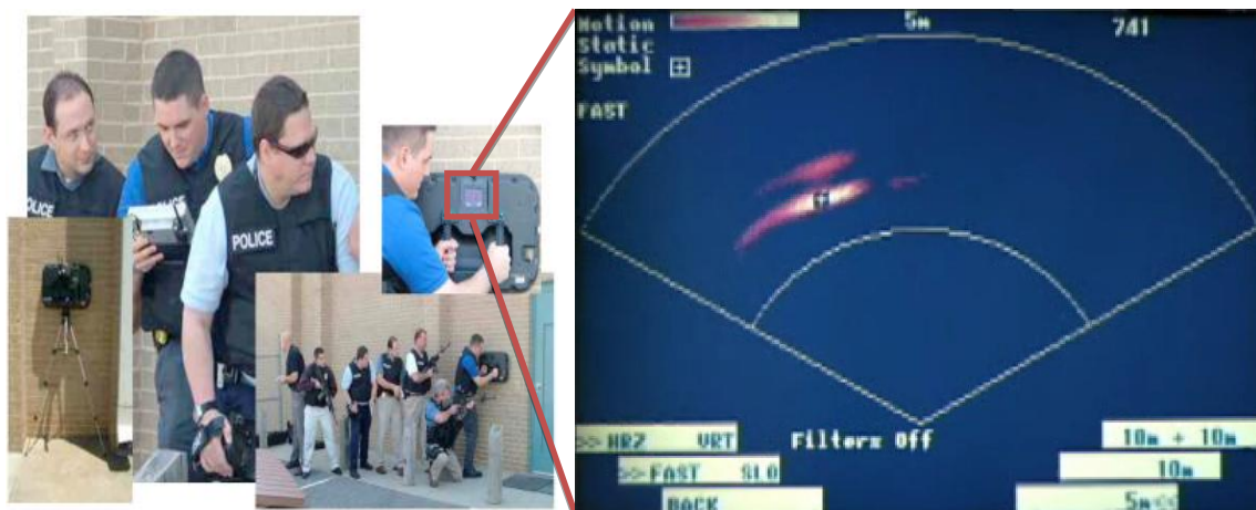
Figure B.2 : test du RadarVision2i®. Résultat de la détection de deux cibles humaines.
