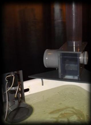
Photo du dispositif d'auto alimentation utilisé pour analyser les stratégies d'approvisionnement en nourriture (Antenne et tige d'activation à gauche et distributeur à droite)
