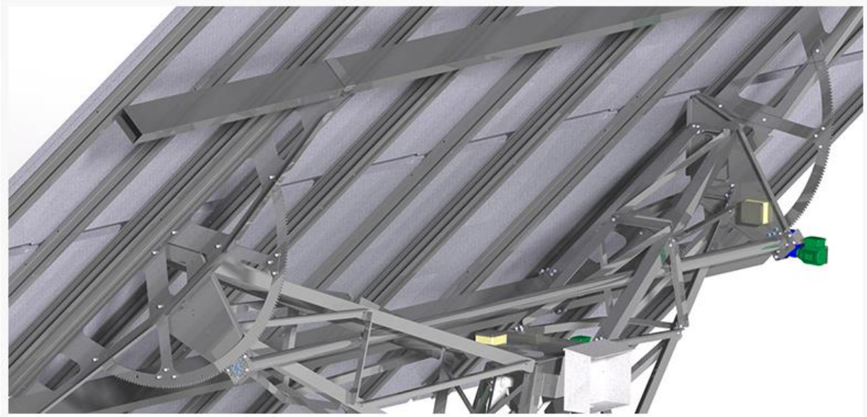
Figure 35- Illustration de la conception mécanique du tracker (Axe d'élévation)
