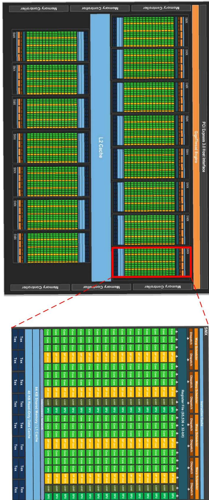
FIGURE 2.4 – Architecture de la plateforme Kepler-GK110 et du processeur SMX de Nvidia [NVIDIA, 2012]
