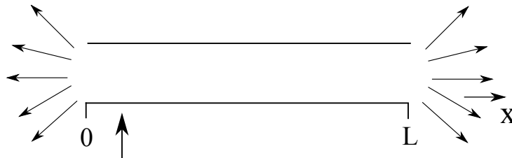
FIGURE 8.1 – Schéma d'un tube ouvert-ouvert de longueur L .
