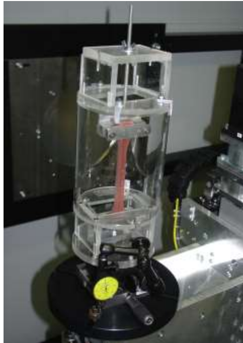
Figure 4.44 Dispositif de traction pour un essai par tomographie RX in situ
