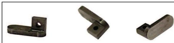
Figure 2-15 : Visuels de l'outil mis au point pour solliciter nos échantillons.
