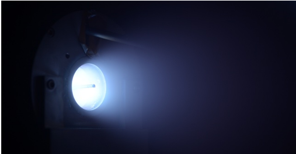
FIGURE 4.3.3 – Propulseur ECR configuration 3 en fonctionnement dans le B61 avec du xénon.
